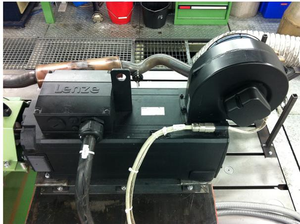
Abbildung 4.3: Asynchronmaschine
