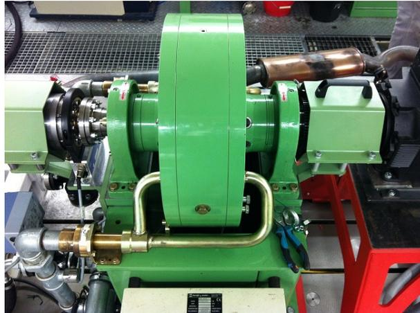
Abbildung 4.4: Wirbelstrombremse
