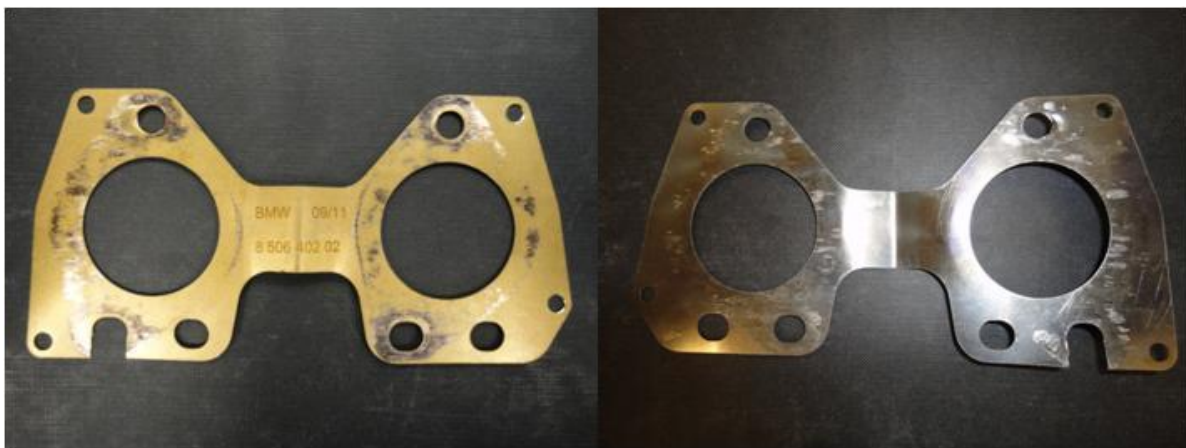
Abbildung 4-31: Gebrauchsspuren an der Gleitlage nach den Versuchen
