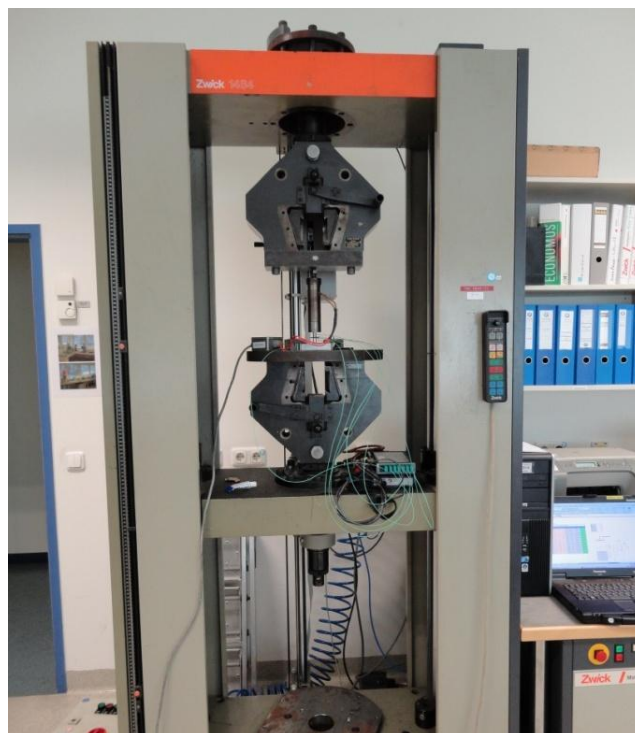
Abbildung 4-4: ZWICK Universalprüfmaschine 1484 mit dem 1. Versuchsaufbau
