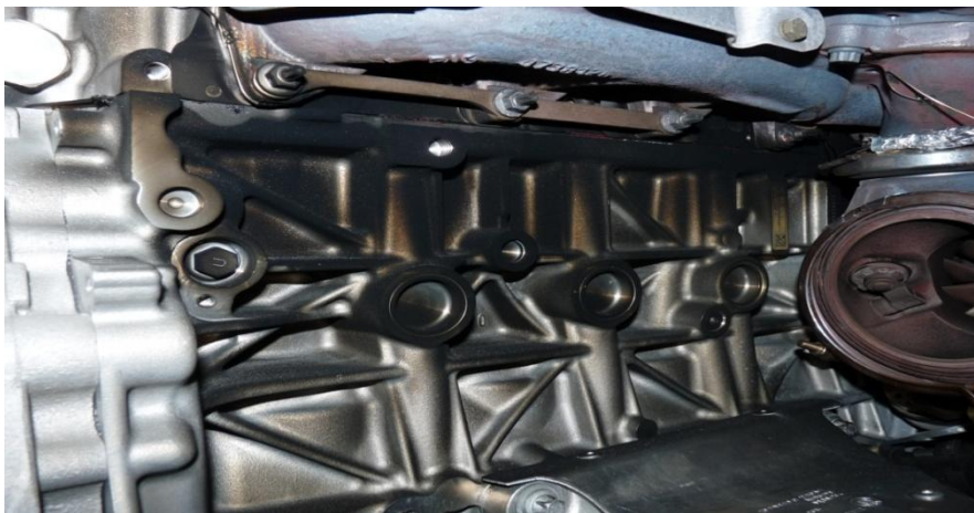
Abbildung 2-10: Undichtheit am AGK durch unzulässig hohen Vorspannkraftabfall
