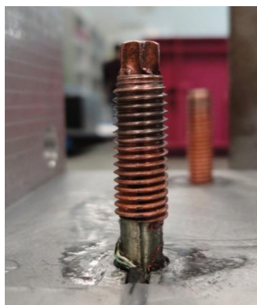
Abbildung 4-32: Abrieb der Kupferschicht an der Stiftschraube
