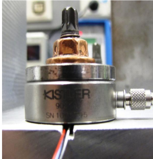
Abbildung 4-44: Stiftschraube mit Kraftmessring zur Ermittlung des Anzugsmoments
