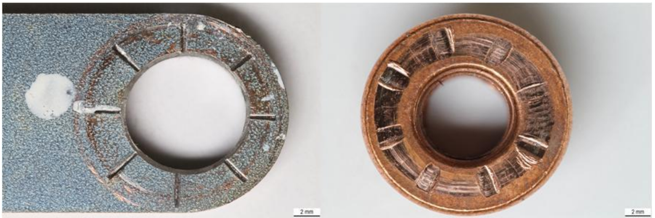
Abbildung 4-43: Abdrücke der Disc Lock Scheiben auf Schiebeleiste(links) und Mutter(rechts)
