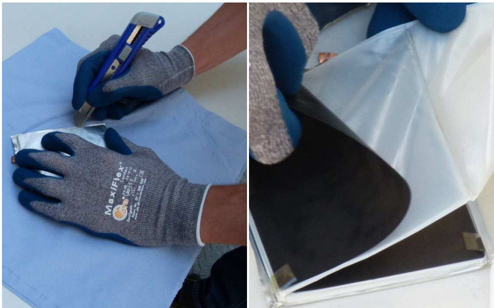
Abbildung 4-2 Öffnen der Lithium-Ionen-Batterie
