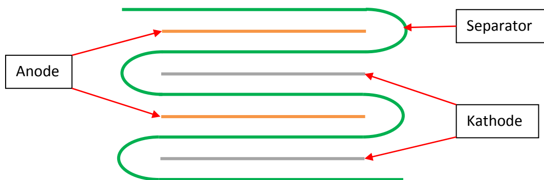
Abbildung 4-4 Anordnung des Separators in der Zelle
