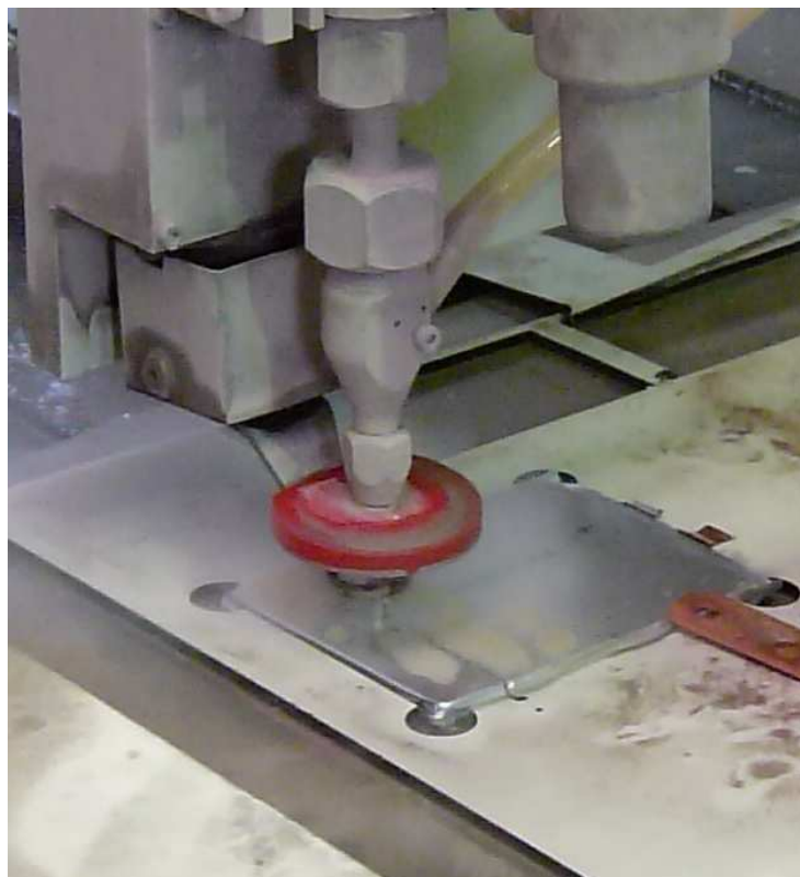
Abbildung 4-14 Probenherstellung durch Wasserstrahlschneiden
