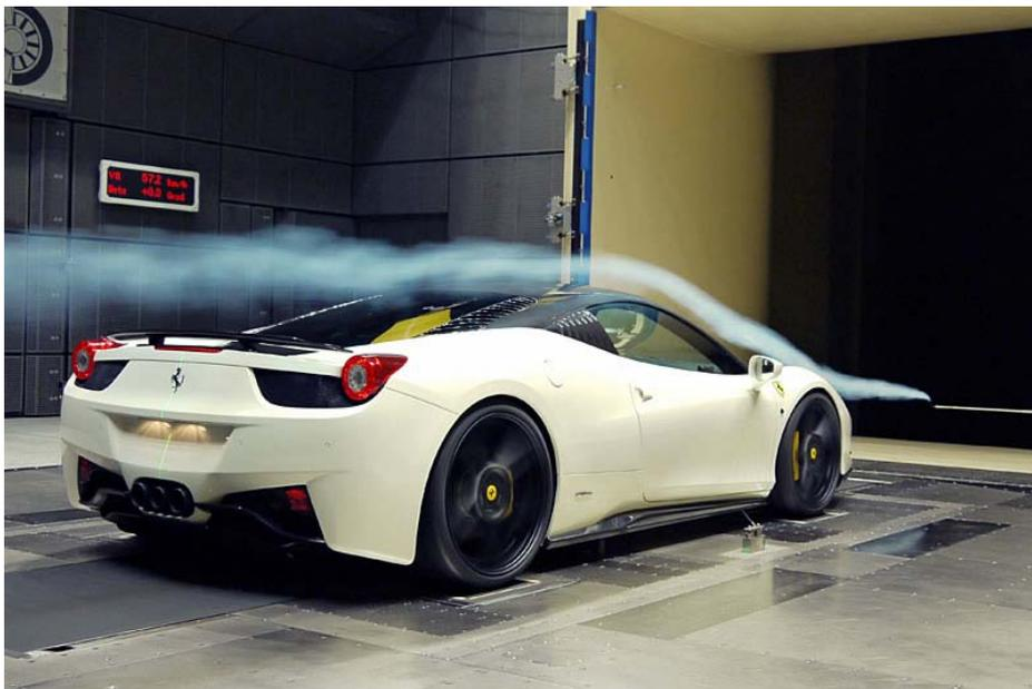
*Abbildung 2.23: Strömungsvisualisierung mit Rauchlanze [17]*
