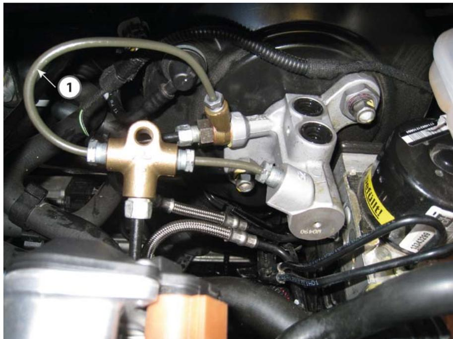
Abbildung A-2: Bremsleitungen am HBZ mit Kurzschlussleitung (1)
