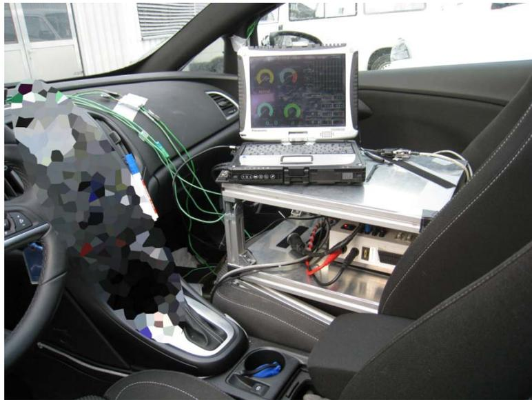
Abbildung 3.12: Verbautes Messsystem im Fahrzeug
