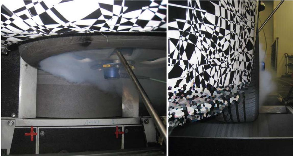
*Abbildung 5.27: Saugwirkung in den Radkästen (Felge Standardkonfiguration)*
