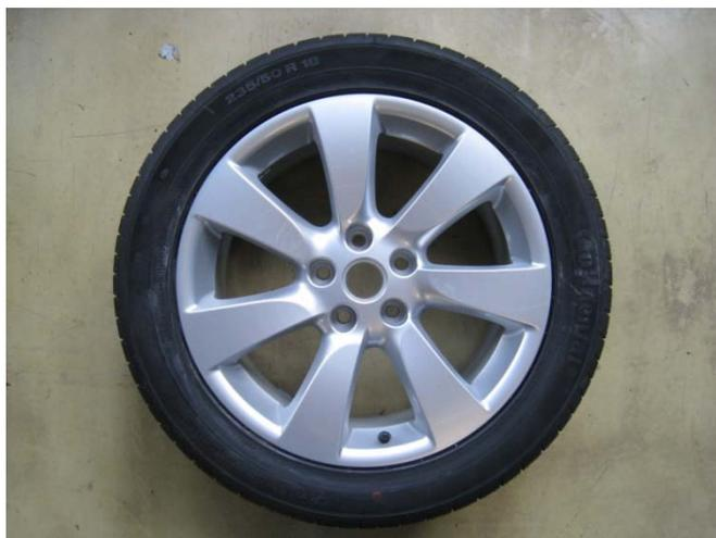
*Abbildung 3.5: Vergleichskonfiguration F2 18“-Rad 7 Speichen symmetrische Öffnungen*
