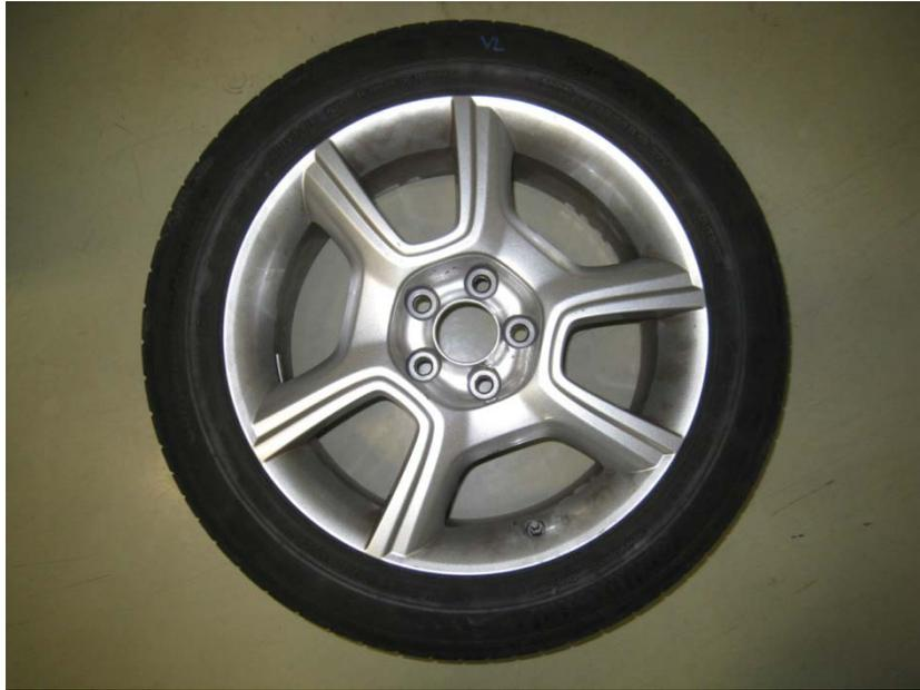
Abbildung A-1: Leichtmetallfelge 18" mit symmetrischen Öffnungen (Realerprobung)
