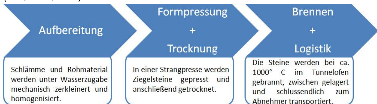
Abbildung 60: Herstellungsprozess bei der Ziegelproduktion (Kuc)
