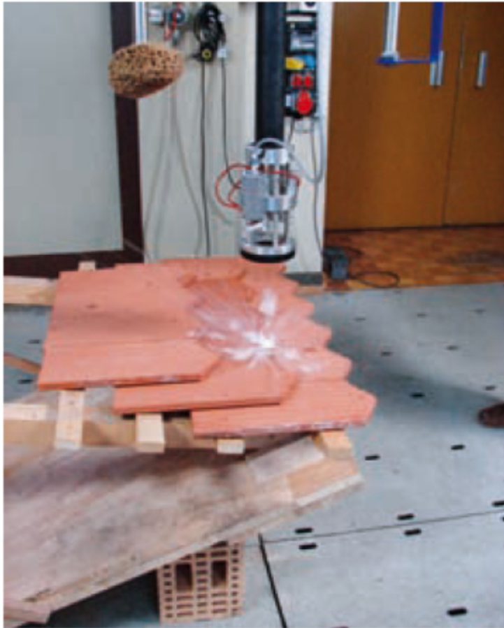
Abbildung 15: Hagelkanone mit aufgebauten Ziegeln, Foto EMPA 94
