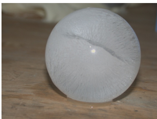
Abbildung 56: Eiskugel, die mit Lufteinblasfunktion erschaffen wurde
