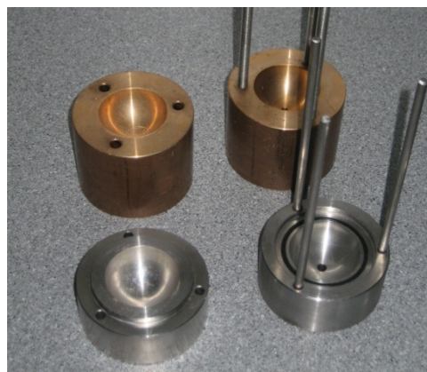
Abbildung 51: Hagelformen aus Kupfer und Niro
