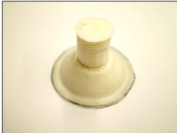
Abbildung 3-1: Abguss des Kompressionsvolumens
