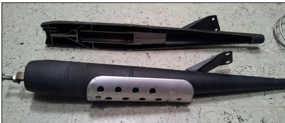
Abbildung 3-5: Geschnittenes Modell und Auspuff des Prüfstands
