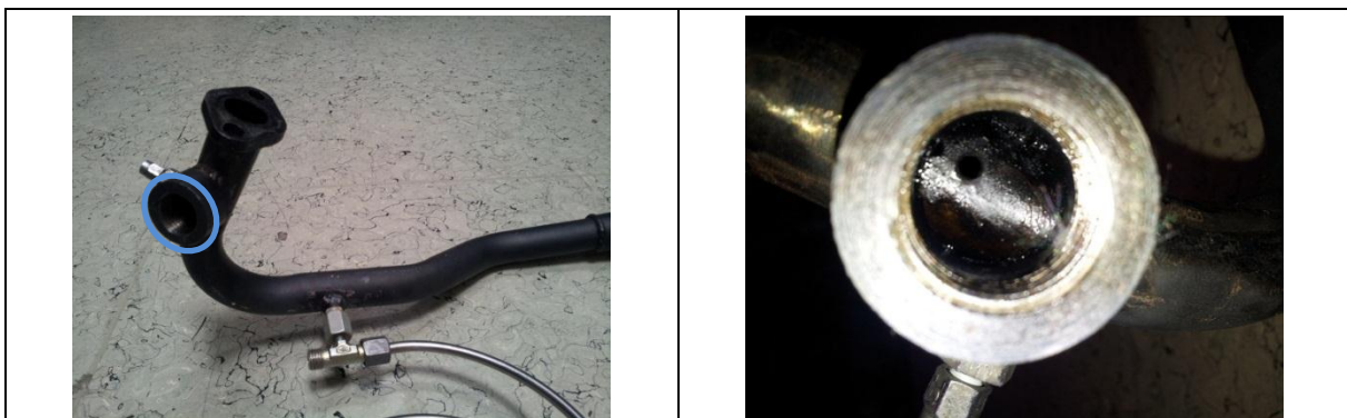
Abbildung 3-21: Auslassdruckmessstelle am Prüfstand
