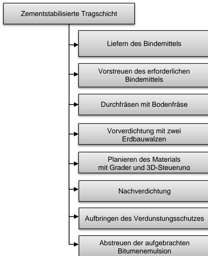
Bild 4.14: Vorgänge bei der Tragschichtstabilisierung mit Zement
