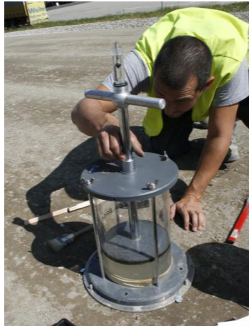
Bild 4.4: Densitometer-Verfahren zur Ermittlung des Verdichtungsgrades
