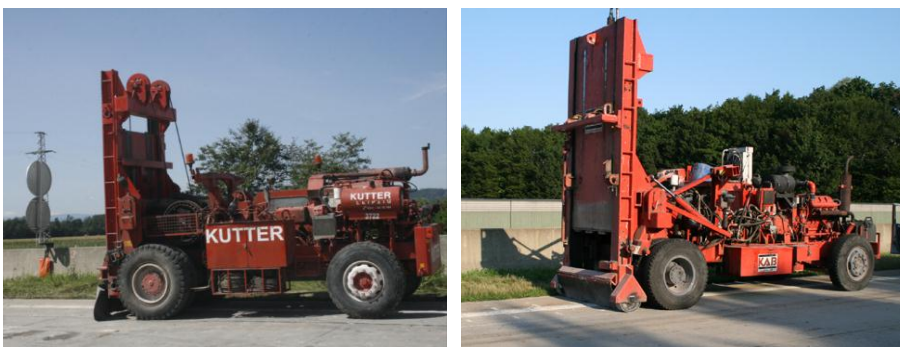
Bild 3.5: Betonzerstörer (links mit Seilzug; rechts mit Hubkolben)
