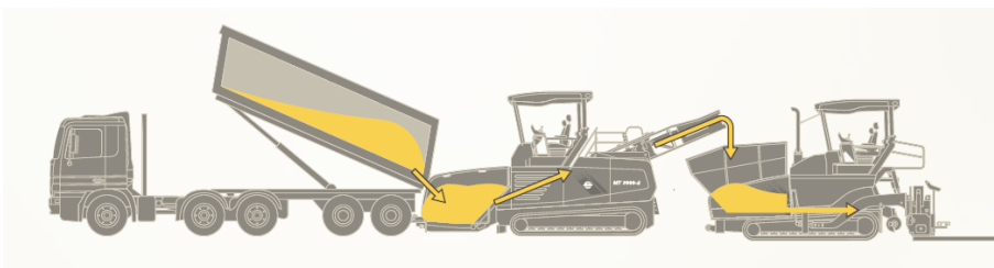
Bild 5.12: Funktionsprinzip eines Beschickers 87
