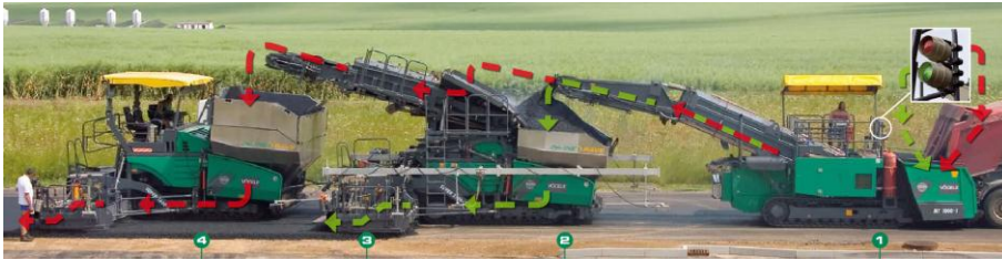
Bild 5.11: In-Line Pave Einbauzug 86
