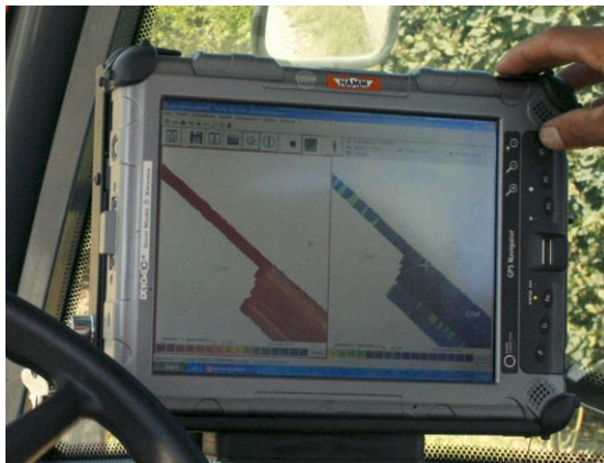
Bild 4.9: Anzeigedisplay in der Fahrerkabine (Flächenplot)
