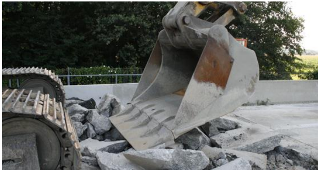
Bild 3.8: Löffel mit verlängerter Schneide
