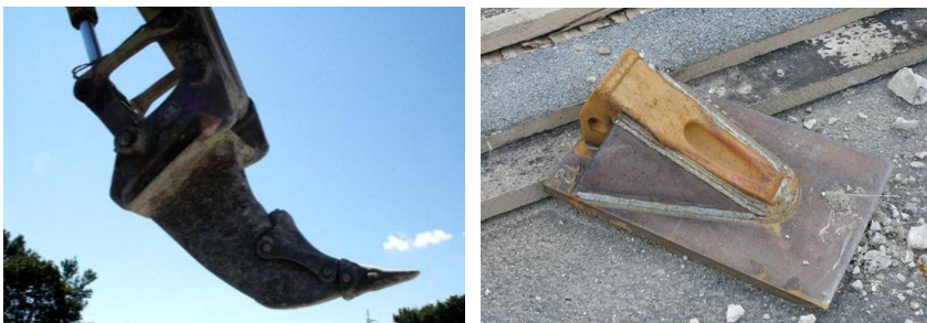
Bild 3.7: Herkömmlicher und modifizierter Reißzahn
