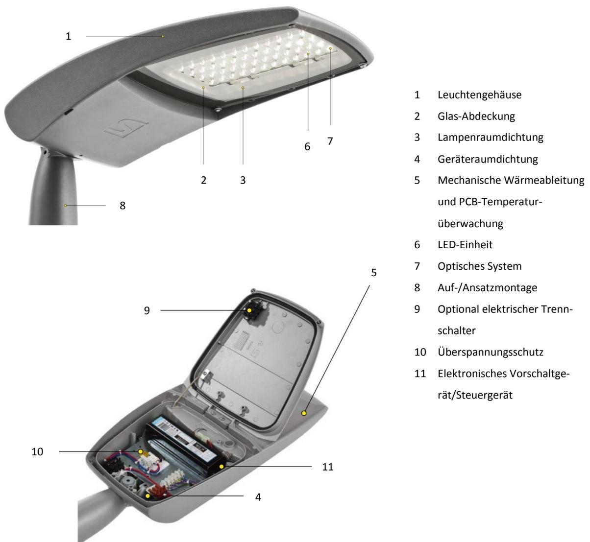
Abbildung 3-3: Aufbau einer LED-Leuchte der Firma AE Schröder, Typ TECEO (Abbildung modifiziert, Quelle Originalbild:[23])
