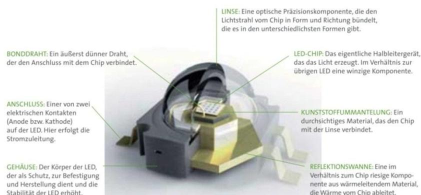
Abbildung 3-4: Aufbau einer Hochleistungs-LED [24]
