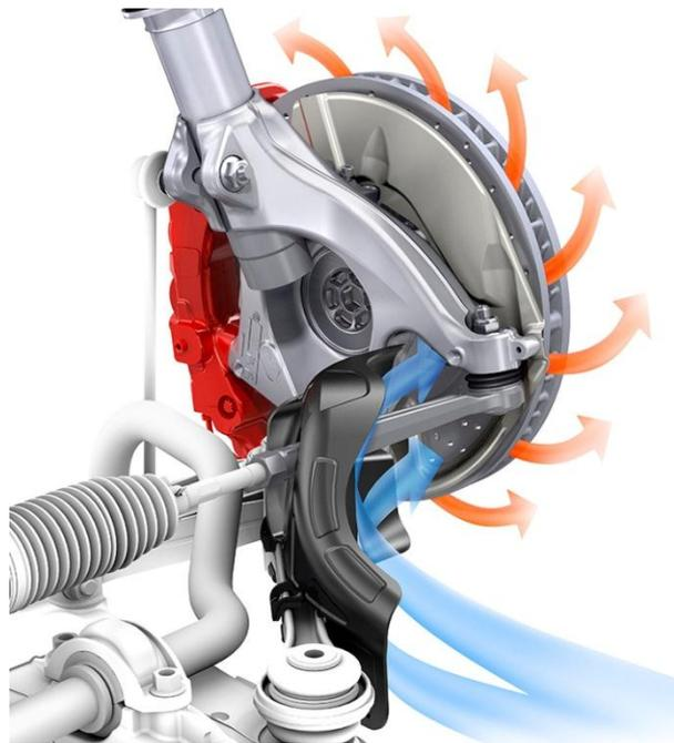
Abbildung 1.6.: Gezielte Bremsscheiben-Belüftung
