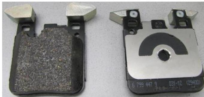
**Abbildung 5.1.: Hinterachse-Bremsbelag eines Wettbewerbers mit Bremsbelagsmassen, Parallelchamfers, heißgeklebtes Shim und Clip-on Shim mit „Moon-Cut“**
