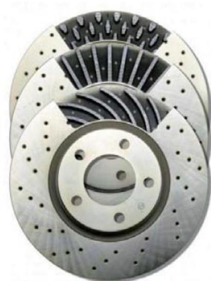
**Abbildung 1.5.: Verschiedene Kühlkanal- Designs von innenbelüfteten Bremsscheiben [1]**
