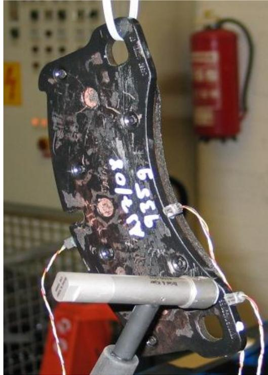
Abbildung 3.3.: Eigenfrequenzanalyse Bremsbelag [25]
