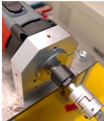
Abbildung 7.8.: Montage der Antriebsmaschine
