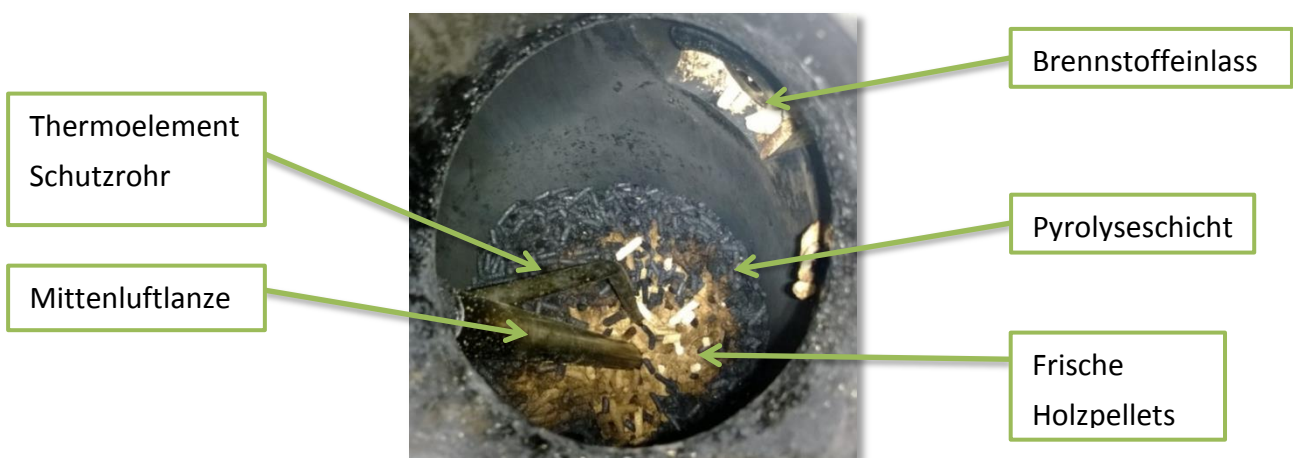
Abbildung 5-10: Blick in den Reaktorraum oberhalb der Luftdüsen.
