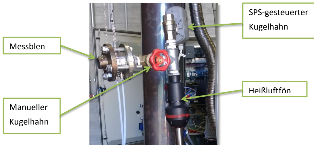
Abbildung 5-14: Kugelhahn der Mittenluftlanze mit Volumenstrom Messblende
