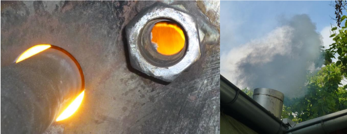
Abbildung 4-36: Flamme und Rauchgas bei der CWS Verbrennung mit Sauerstoff angereicherter Luft
