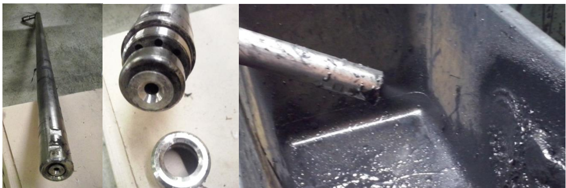
Abbildung 4-22: Lanze und Spraybild von CTP-DUMAG GmbH mit 5,5 mm Düsendurchmesser bei ca. 80 kg Slurry/h; Slurry ohne Dispergiermittel mit 55 wt% Wassergehalt
