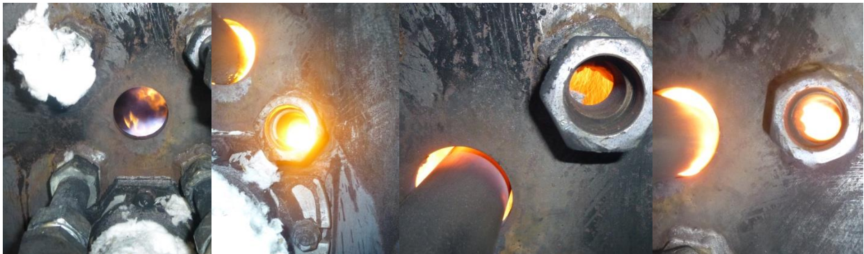
Abbildung 4-34: Flammenvergleich von links nach rechts: Erdgasflamme; Slurry- und Erdgasflamme; Slurry- Flamme mit angereicherter Luft; Slurry- Flamme mit Reinsauerstoff
