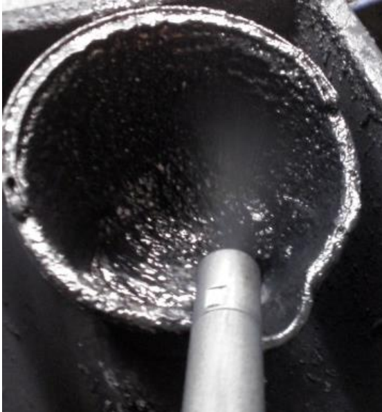
Abbildung 4-25: Spraybild bei der CTP-DUMAG GmbH Lanze mit 6,5 mm Düsendurchmesser bei ca. 180 kg Slurry/h; Slurry ohne Dispergiemittel mit 55 wt% Wassergehalt
