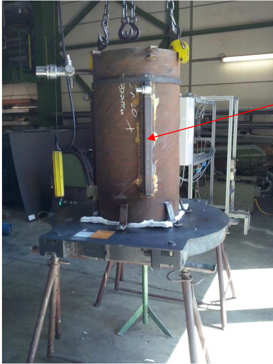
Abbildung 4-12: Montage der Vorbrennkammer auf der Kesseltüre
