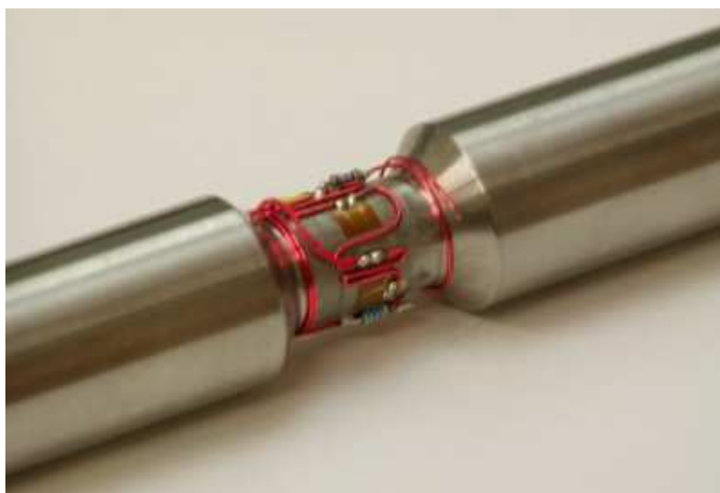
Abbildung 3-1 Welle mit DMS Messtechnik [6]
