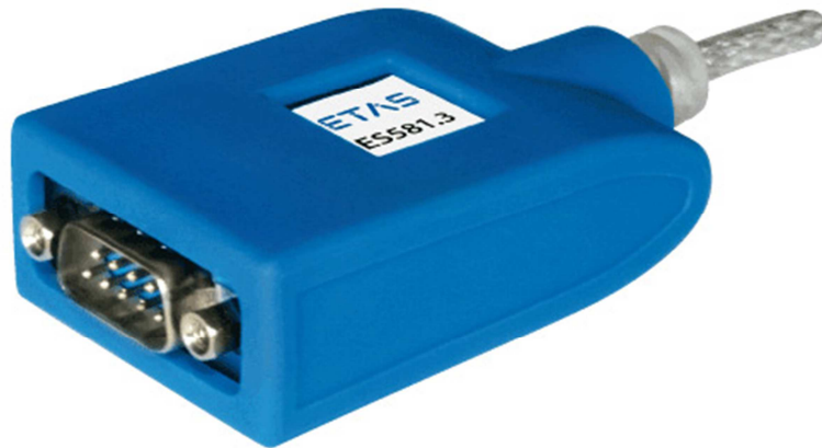
Abbildung 4-7 ES581 – USB CAN-Bus Schnittstellenmodul [9]
