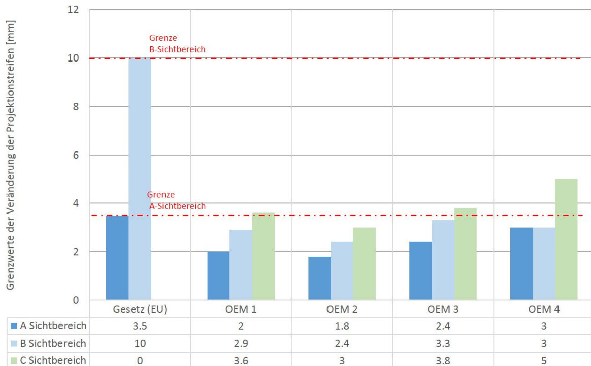
Abbildung 64: Fahrzeughersteller (OEM) Spezifikationen Zebraobjektion
