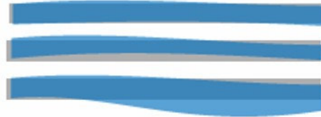
Abbildung 62: Visualisierung der Änderung der Projektionsstreifen im Zebratest horizontal
