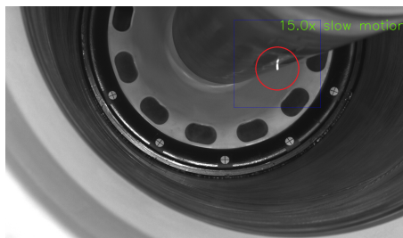
Abbildung 8-8: Beispiel einer stehenden Bewegung des Partikels an der Oberfläche des Innenleiters
