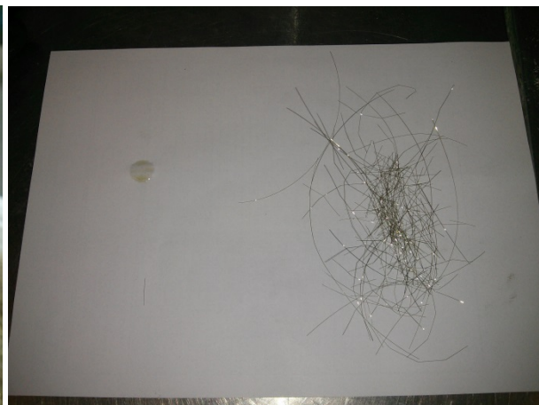
Abb. 4.32: Ausgeschiedener überlanger Feindraht, bei angestrebten 15 mm Faserlänge (li. unten)
