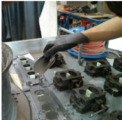
Abb. 4.25: Betonieren der Probekörper mit UHPC-Leim
