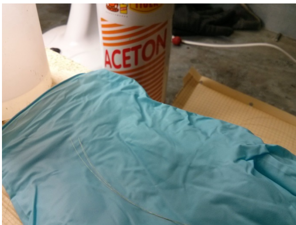
Abb. 4.23: Bereits mit Aceton gereinigte Feindrähte beim Trocknen
