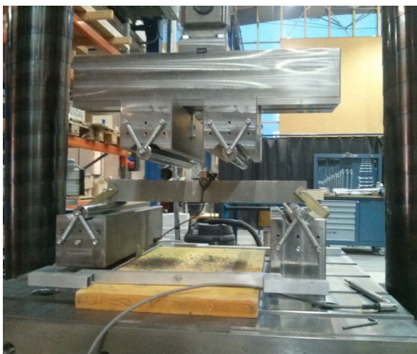
Abb. 4.4: Versuchskörper bei der Vorbereitung für einen Biegezugversuch, WA re. unten
