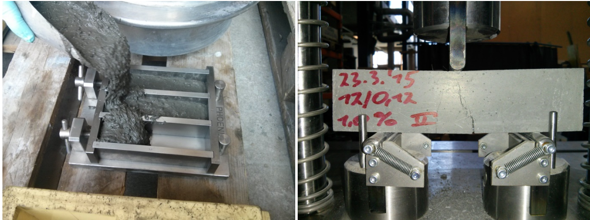
Abb. 4.34: Seitliches Befüllen der Prismenschalung
