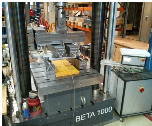
Abb. 4.5: Biegezugversuch mit montiertem WA
