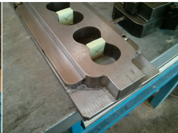
Abb. 4.24: Mit Silikon gedichtete Schalung vor dem Betonieren
