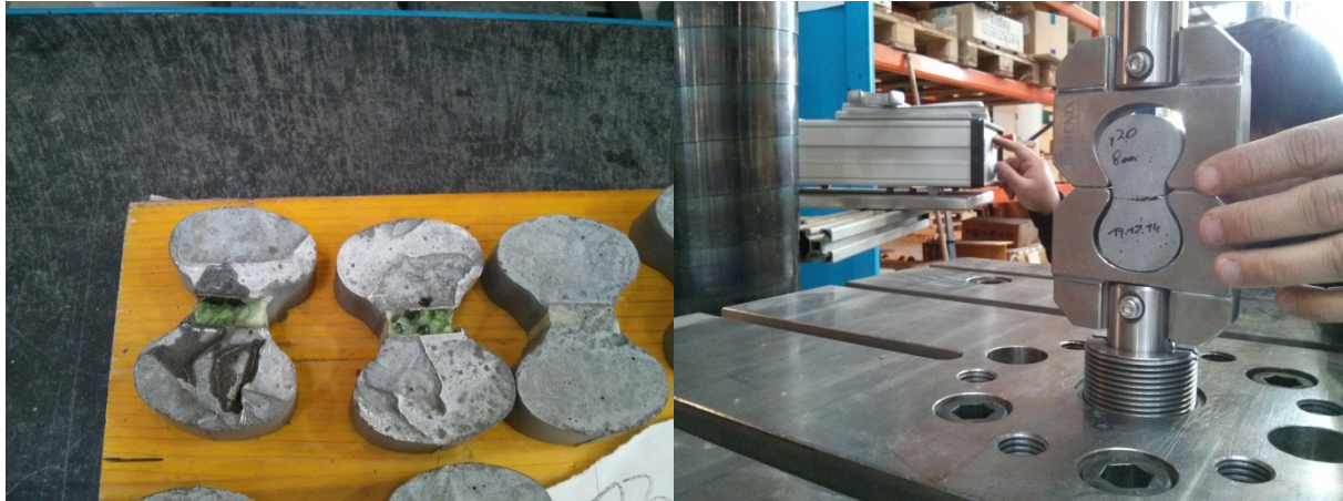
Abb. 4.13: Ausgeschalter Versuchskörper (re.) und mit Aceton beträufelte XPS-Plättchen (li. und mi.)
