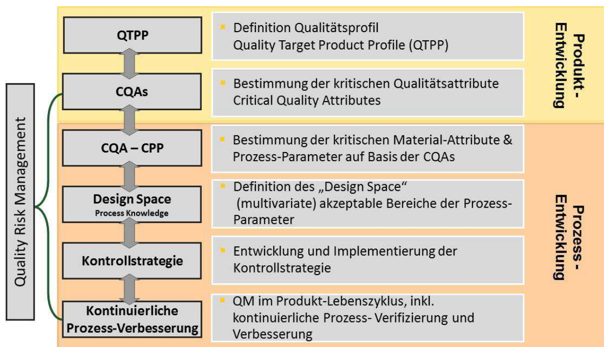
Abbildung 4: Entwicklungsprozess nach dem QbD-Konzept [2]
