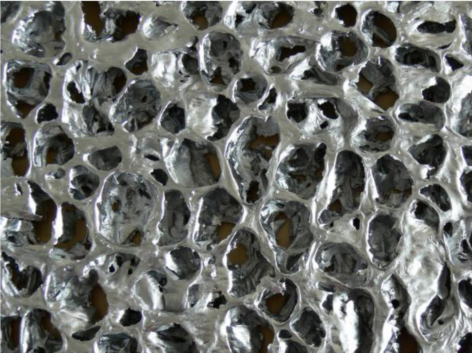
Abb. 105 Detailaufnahme Geschäumtes Aluminium
