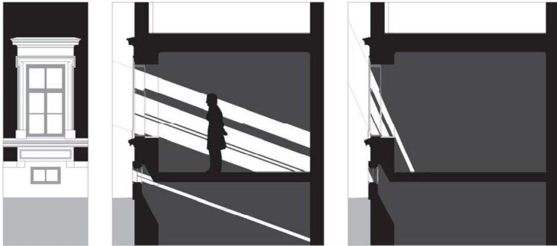
Abbildung 55 – Lichteinfall des Kastenfensters im Winter (Mitte) und im Sommer (rechts)
