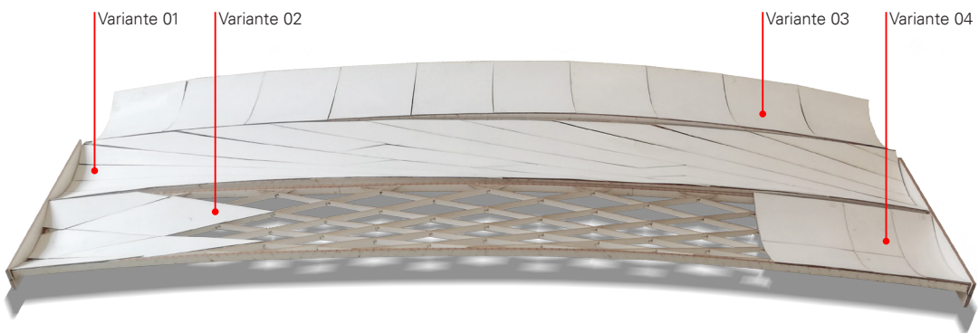
Foto Arbeitsmodelle M 1_25, Auflager, Tesselierungs- und Abwicklungsstudie
