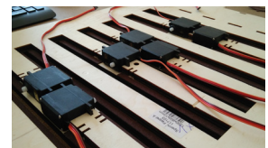
Abb.4.8: Positionierung der Motoren auf der Grundplatte. Links- und rechtsdrehende Logiken.
