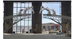
Abb.1.27: MX3D's additiv 3D gedruckte Brücke, bei der der Druckkopf mit dem Gebäuden wandert, soll schon bald in Amsterdam realisiert werden
