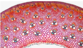
Abb.1.31: Gradienter Aufbau eines Bambus Rohres
