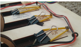
Abb.4.27: Elastische Lagerung der Ankerpunkte um nach innen rutschen zu können
