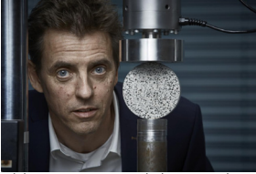
Abb.1.38: Hendrik Jonkers selbstheilender Beton schließt Risse durch kalkproduzierende Bakterien
