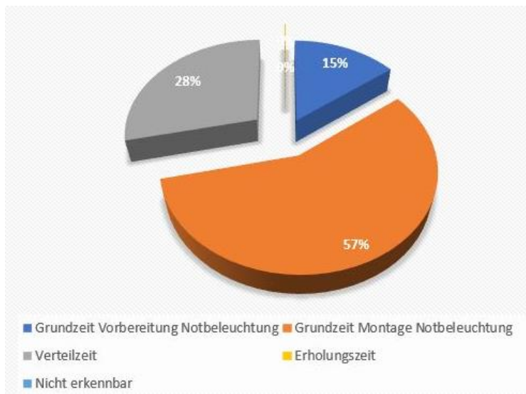
Abbildung 6-55: MG – Grundzeit aufgeteilt/Verteilzeit/Erholungszeit – Notbeleuchtung
