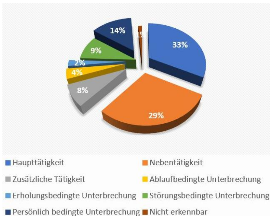
Abbildung 5-7: MC - Zusammensetzung der Zeit für alle Kabelzüge
