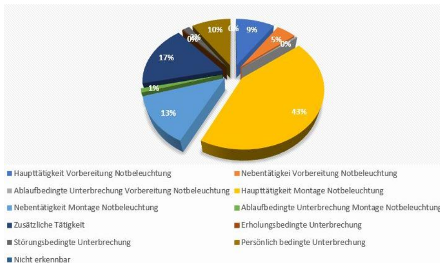
Abbildung 6-57: MG - Zusammensetzung der Zeit für die Notbeleuchtung
