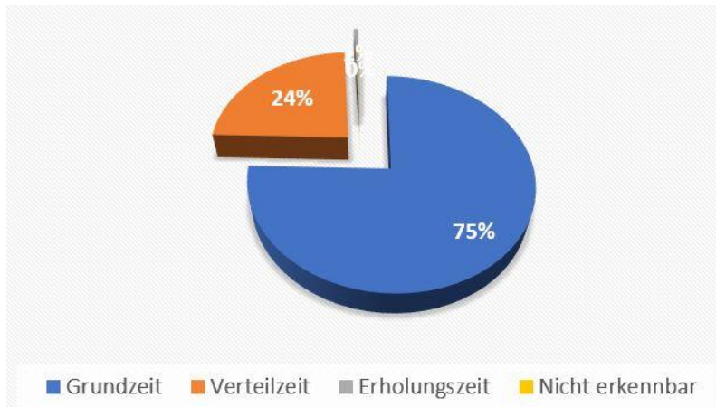
Abbildung 6-4: MG - Grundzeit/Verteilzeit/Erholungszeit – Kabelzug Brandmeldeleitung
