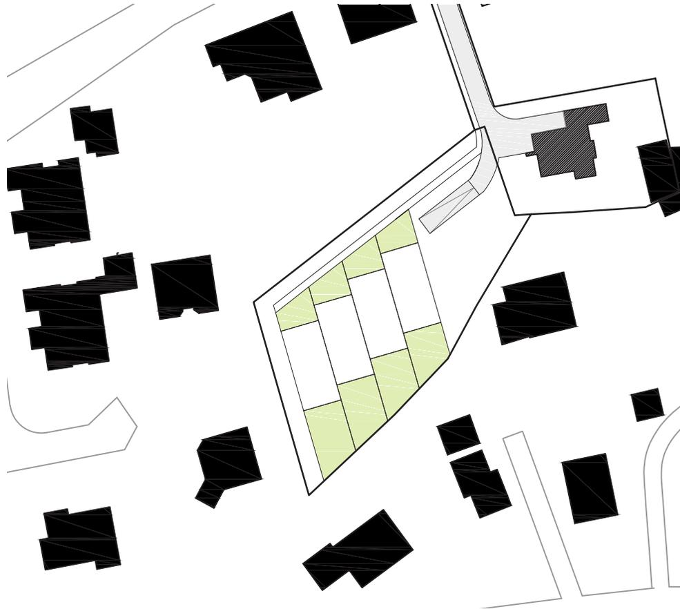
Dieser Plan zeigt die Organisation der Volumen am Grundstück. Die Erschließung erfolgt mit dem Auto über die Tiefgarage, zu Fuß nordseitig hinter den Häusern. Die vier Einheiten sind gegliedert in Vorgarten - Gebäude - Garten. Durch die Ausrichtung der Gebäude an der Geländekante ergeben sich optimale Ausblicke auf die Karawanken sowie bereits definierte Vor- und Terrassenzonen.
