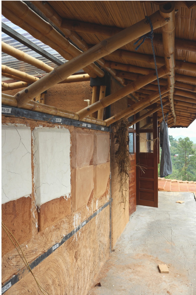
Abb.100: Abari, Dulikhel Learning Center, Dulikhel, Testreihe von verschiedenen Lehmputzen, 10/2016
