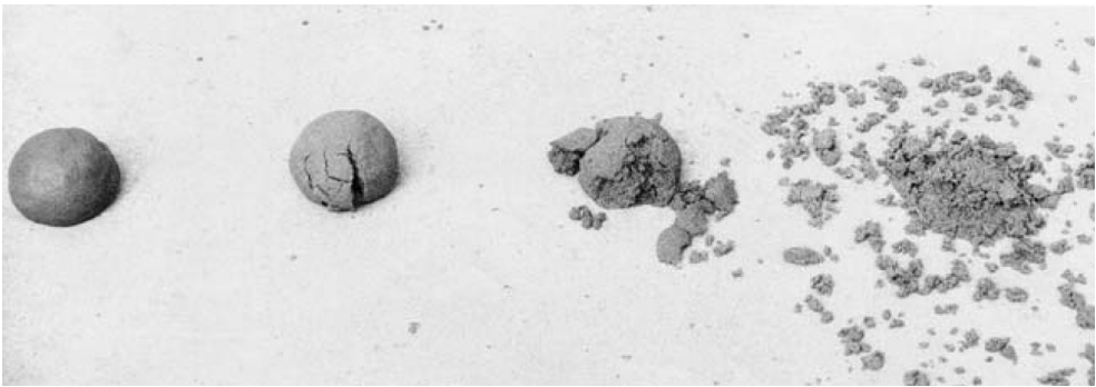
Abb. 32: Kugelfalltest; Links aussen sehr toniger Lehm, rechts aussen sehr sandiger Lehm, Zweite Probe von links hat noch eine sehr gute Bindekraft, die dritte von links hat fast gar keine Bindekraft mehr.
