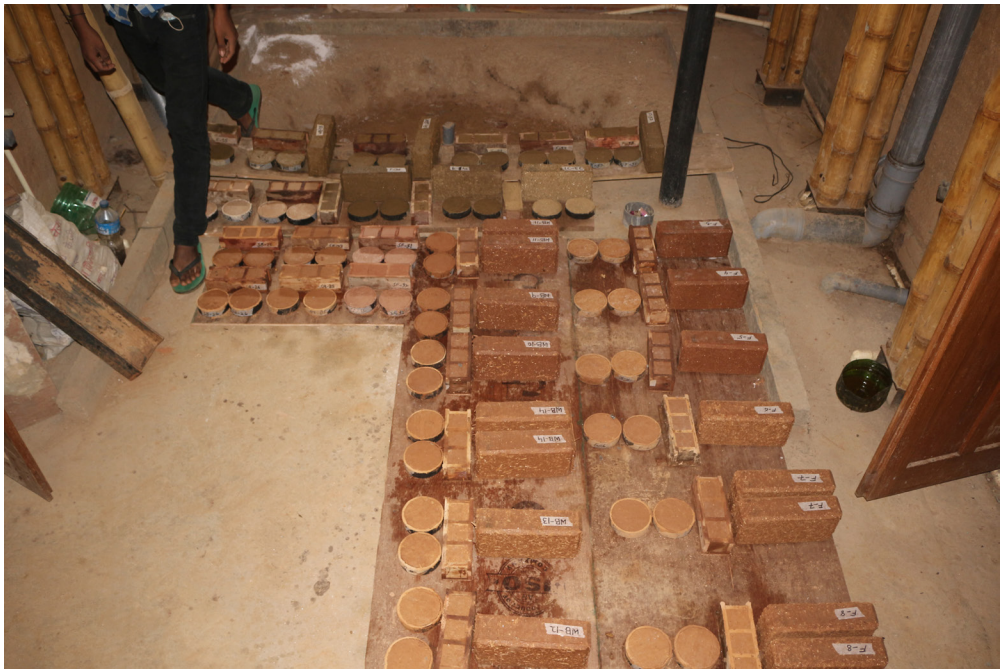
Abb.105: Abari, Dulikhel Learning Center, Dulikhel, Testreihe Lehmziegel mit Zuschlägen aus Stroh, 10/ 2016
