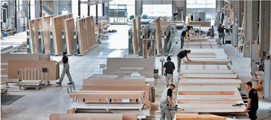
Bild 1.1 Vorfertigung im Holzbau<sup>3</sup>
