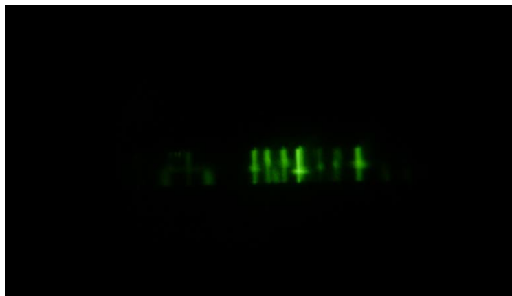
Bild 3-32: Aufnahme des Coronafinders der Entladungen am Platte-Platte-Modell ohne Spacer mit d = 10 mm und einer relativen Luftfeuchte von 80 % sowie Temperatur B
