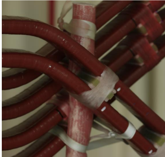
Bild 4-20: Wickelkopfanordnung mit eingebautem Stützschlauch zwischen Oberlage und Unterlage
