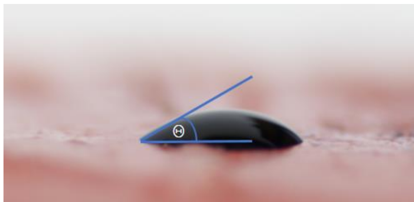
Bild 3-28: 20- \mu\text{l} -Tropfen angebracht an der Isolierstoffoberfläche der Stab-Stab-Anordnung zur Bestimmung des Kontaktwinkels
