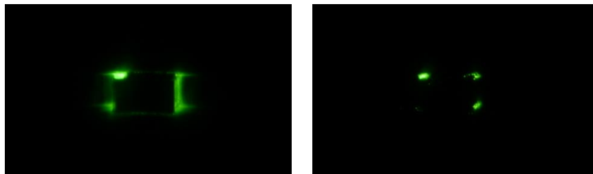
Bild 4-23: Aufnahme des Coronafinders der Stab-Stab-Anordnung mit unvorteilhaftem Spacer – Links bei 30 % r.F. und Temperatur B, Rechts bei 80 % r.F. und Temperatur B
