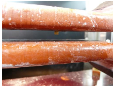
Bild 3-10: Prüfling B1 – Stab-Stab-Anordnung mit definierter Inhomogenität
