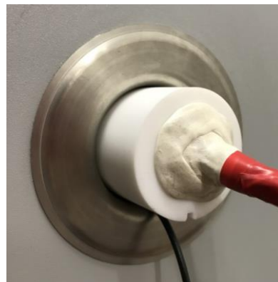
Bild 3-20: Gefertigte Hochspannungsdurchführung für den Klimaschrank
