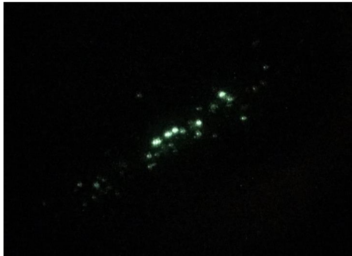
Bild 3-39: Aufnahme des Coronafinders der Entladungen in der Unterlage des Wickelkopfmodells bei 80 % r.F. und Temperatur B
