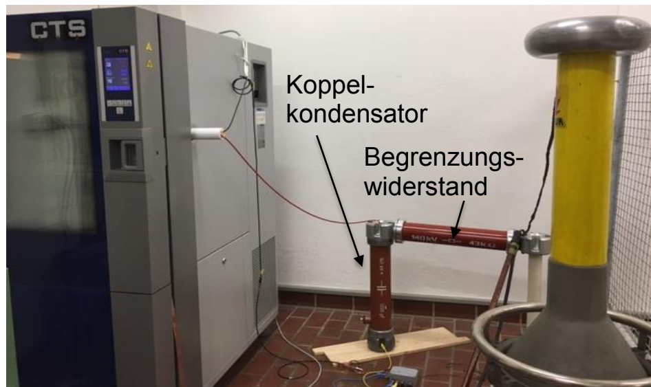
Bild 3-18: Messaufbau der Messungen im Klimaschrank
