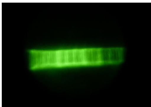
Bild 3-56: Coronafinderaufnahme bei Einsetzen der Entladungen ( \hat{U}_{CIV} = 42,7 \text{ kV} ) am Stab-Stab-Modell ohne Spacer für d = 15,6 \text{ mm} bei einer relativen Luftfeuchte von 20 % und Temperatur D
