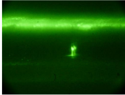
Bild 4-25: Aufnahme des Coronafinders bei Messung des Stab-Stab-Modells mit definierter Inhomogenität bei 80 % r.F. und Temperatur B
