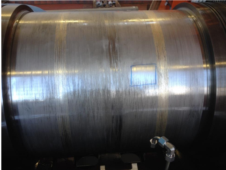
Abbildung 4-13: Beschädigte Läuferwelle verursacht durch Wellenstromfluss (Quelle: Andritz Hydro)
