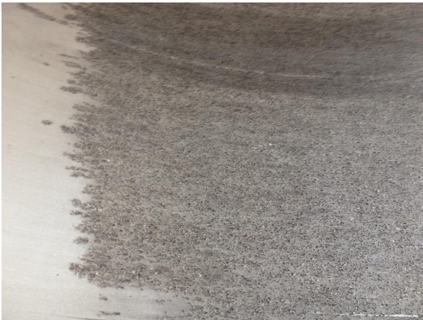
Abbildung 4-12: Detailansicht der zerstörten Lagerschalenoberfläche (Quelle: Andritz Hydro)
