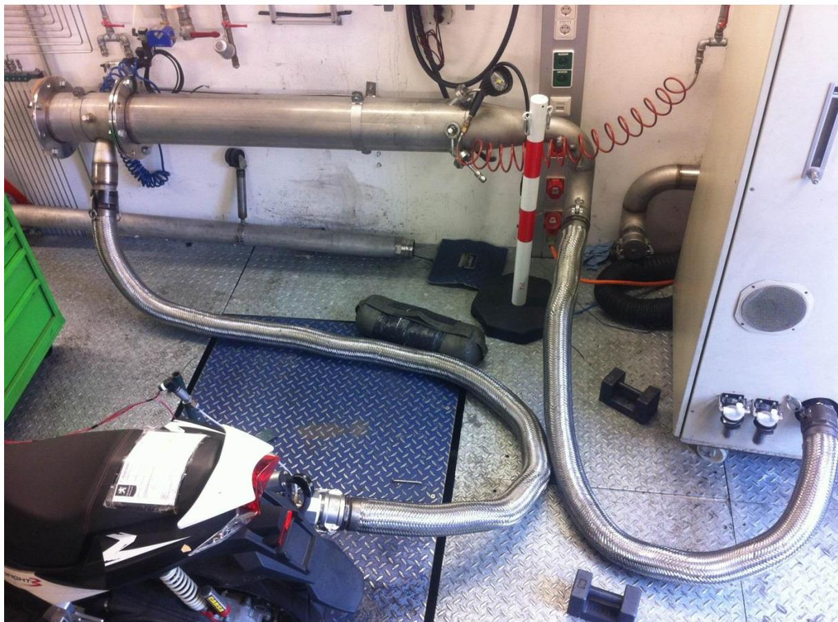
Abbildung 3-23: DT Umbau für geschlossene CVS
