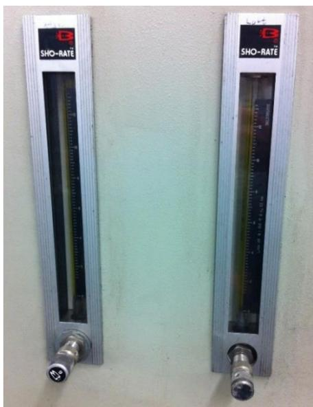
Abbildung 3-8: Schwebekörper-Volumenstrommesser und Regler Brooks SHO-RATE 1355G
