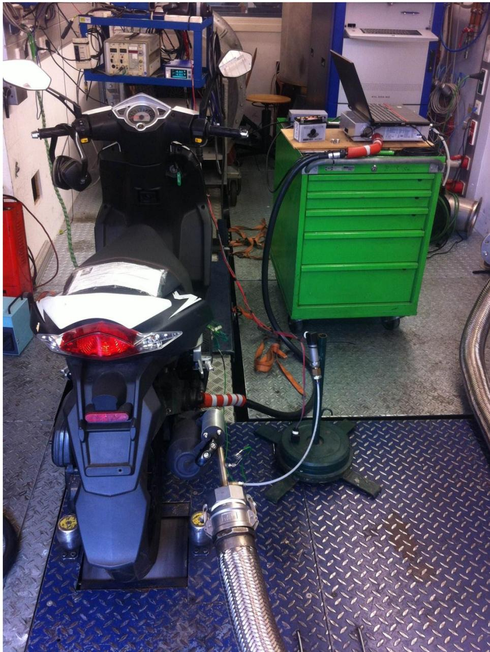
Abbildung 3-25: Versuchsaufbau für geschlossene CVS Messung
