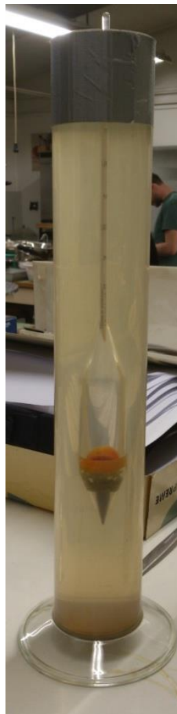
Abb. 4: Absinktiefenmessung mittels Aräometer
