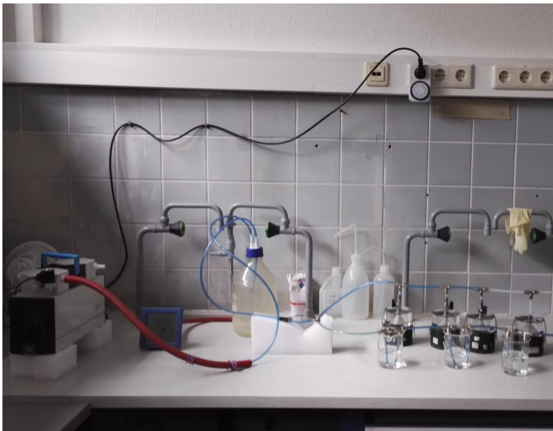
Abb. 17: Systemaufbau für den Entgasungsprozess des Verdunstungsversuchs
