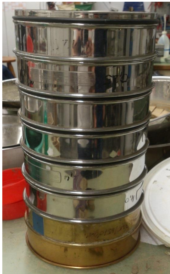
Abb. 3: Siebturm des geotechnischen Labors des Institutes für Bodenmechanik und Grundbau der TUG
