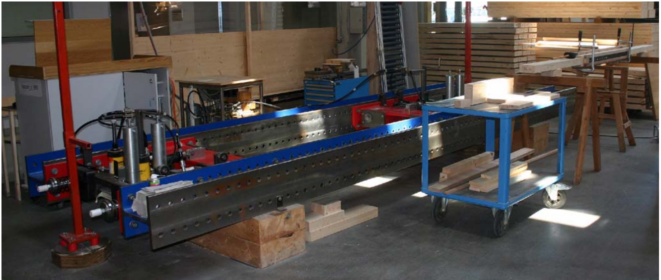
Abb. C.2: Zugprüfmaschine lignum_z_850 des Instituts für Holzbau und Holztechnologie an der TU Graz
