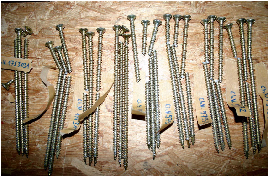
Abb. B.2: Bruchformen der geprüften Schrauben des Typs A1
