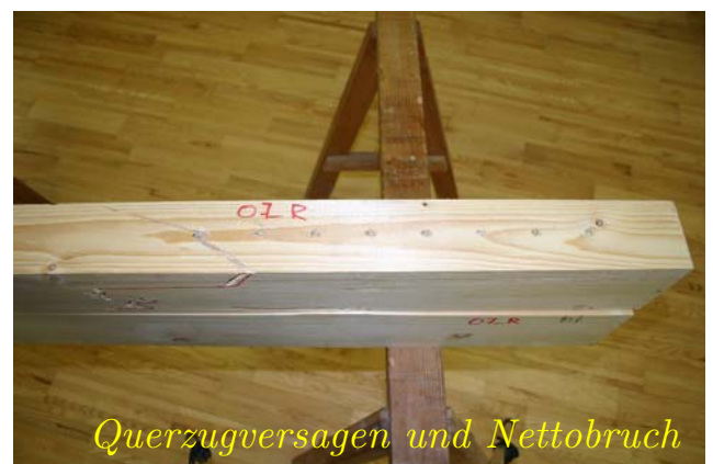
Abb. D.1: Bruchformen in den Vorversuchen: Querzugversagen, Aufspalten, Nettbruch
