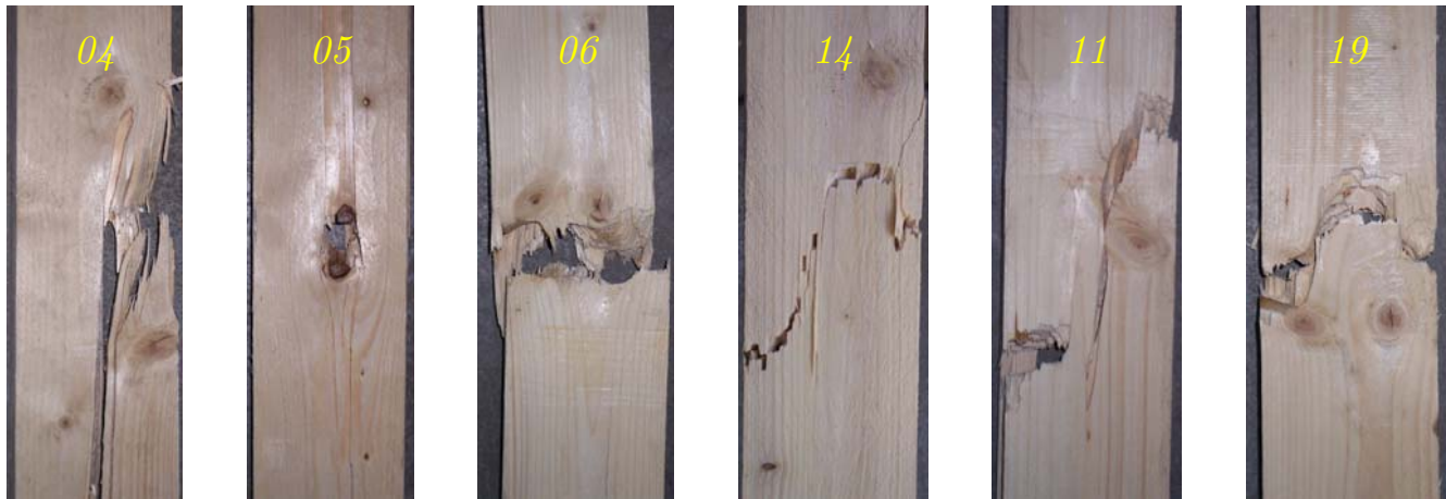
Abb. D.2: Beispiele für einige in den Zugversuchen aufgetretenen Bruchformen der Einzelbretter
