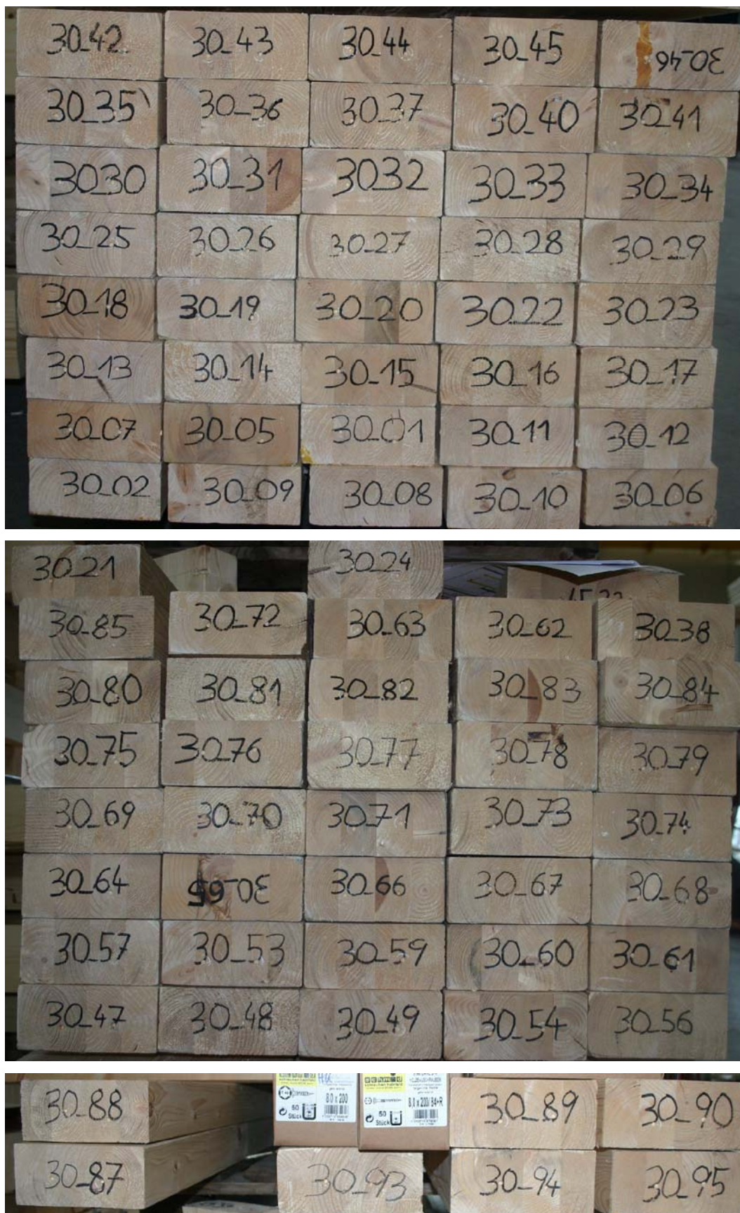
Abb. A.3: Stirnhölzer der Prüfkörper für die 30°-Prüfungen
