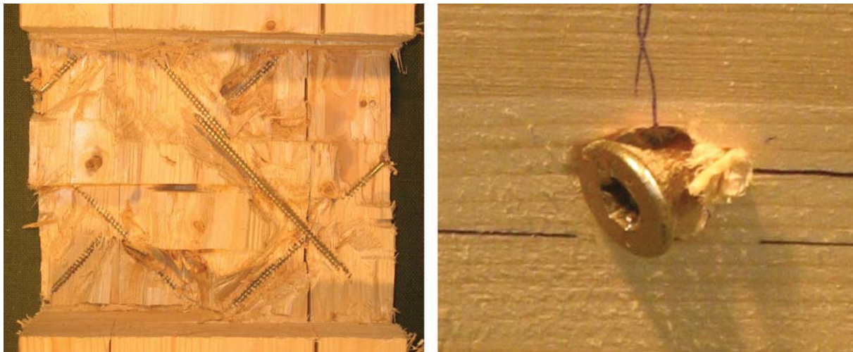
Abb. 3.27: Prüfkörper nach der Prüfung: Bis zur Ebene der Schrauben geöffneter PK mit gekreuzter Anordnung (links) und Herausdrücken des Schraubenkopfes (rechts) (aus [18])
