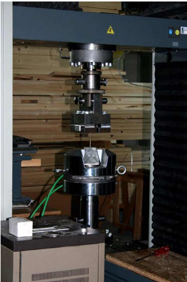
Abb. C.1: Prüfeinrichtung zur Schraubenfestigkeit in der Universalprüfmaschine (links) mit hydraulischer Klemmeinrichtung (rechts)
