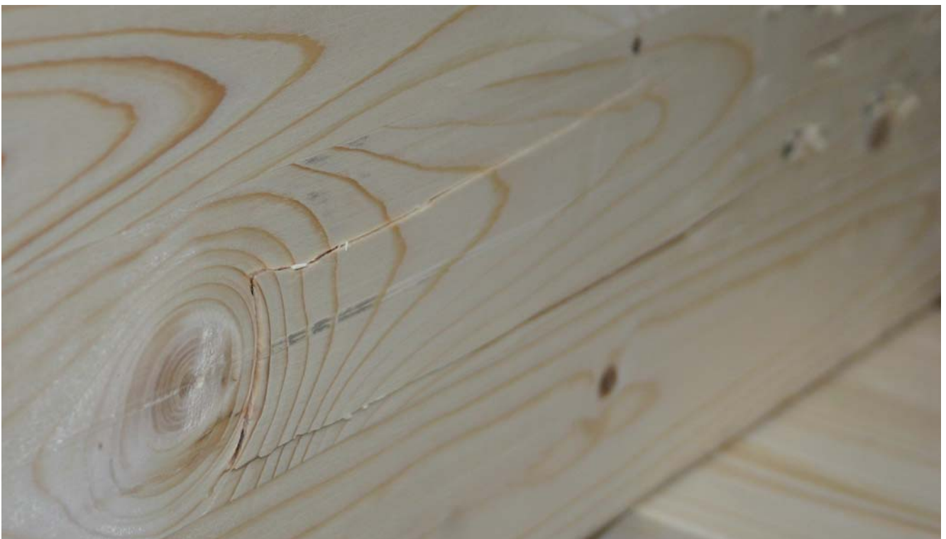
Abb. D.4: Ansatzweises Blockscherversagen beim PK M_8_03
