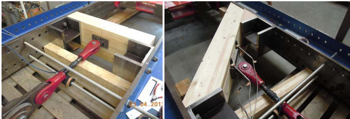
Abb. 3.114: Definition für gesperrte (oben links) und freie (oben rechts) Oberflächen in Verbindungen mit axial bzw. gleichzeitig axial und lateral beanspruchten selbstbohrenden Holzschrauben sowie Prüfkonfiguration für die Gruppenversuche mit 90° (unten links) und 45° (unten rechts) Anordnung (aus [61])
