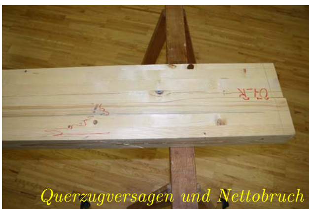
Abb. D.1: Bruchformen in den Vorversuchen: Querzugversagen, Aufspalten, Nettbruch
