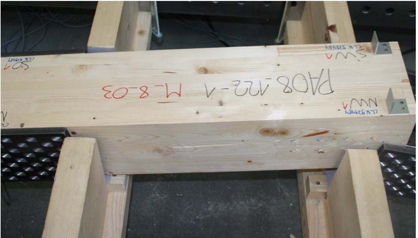
Abb. D.3: Ansatzweises Blockscherversagen beim PK M_8_03
