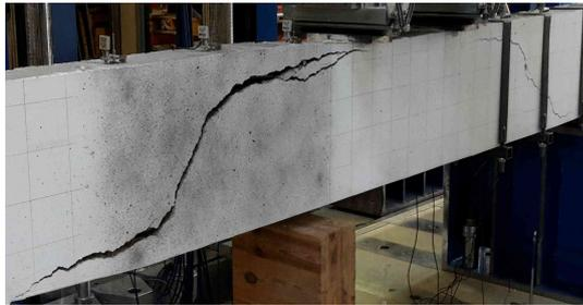
**Abb. 5.5.:** Versuchsbalken SV-1 mit zwei Schubrisse - Ansicht Vorderseite
