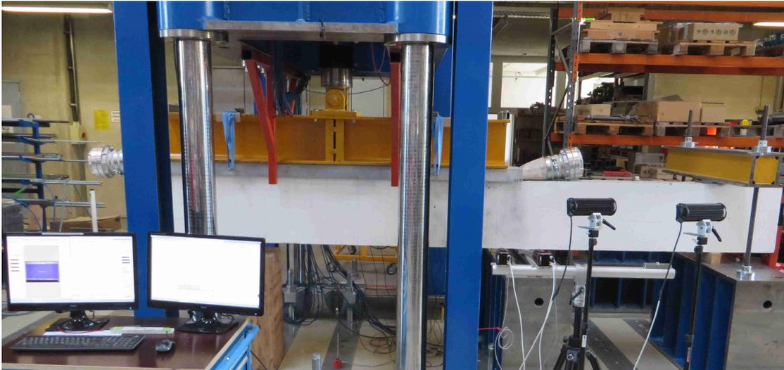
**Abb. 4.11.:** Schubversuch am 1MN-Prüfgerüst mit konventioneller Messtechnik und digitalem Bildkorrelationssystem
