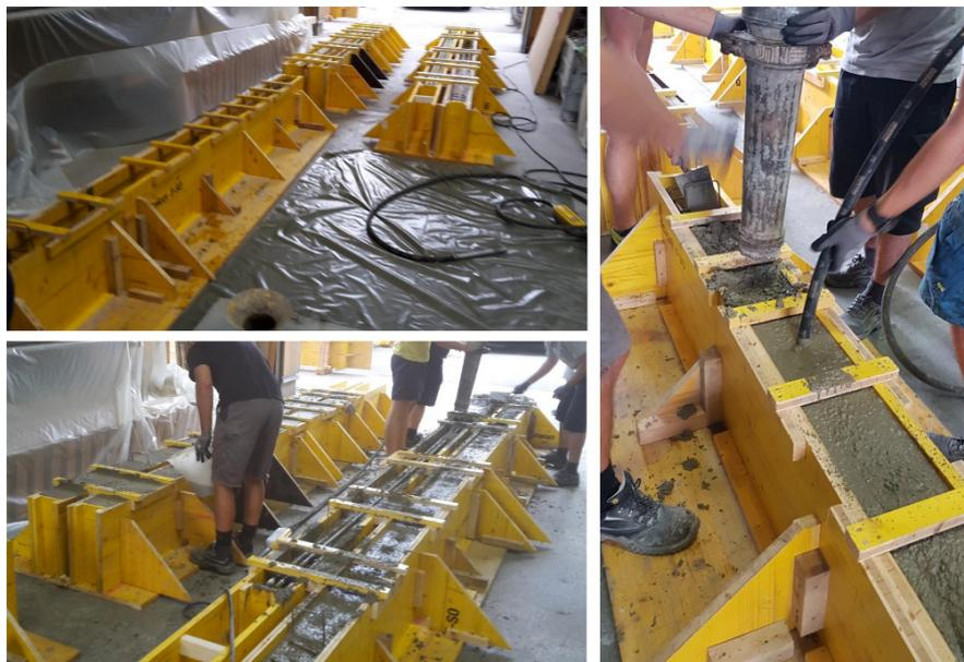
Abb. 4.10.: Betonage der Versuchsbalken und Begleitkörper
