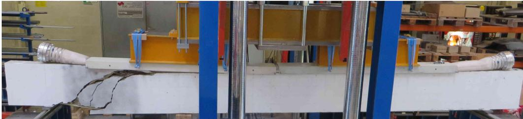
Abb. 5.7.: Schubriss bei Versuchsbalken SV-2 - Ansicht Vorderseite
