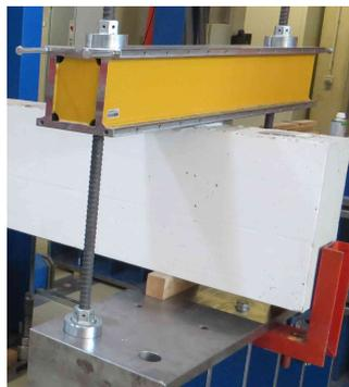
Abb. 4.21.: Rechtes Auflager des Kragbalkens mit Unterlagskantholz
