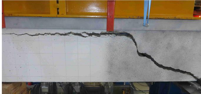
**Abb. 5.9.:** Schubriss bei Versuchsbalken SV-4 - Ansicht Vorderseite
