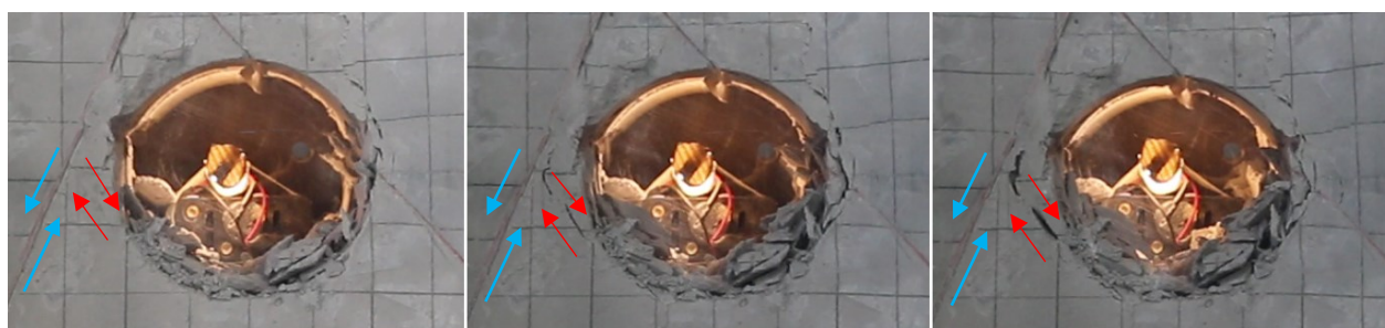
Abbildung 30 MV10 – Bruchentwicklung mit eingezeichneter Scherbewegung (rote Pfeile)
