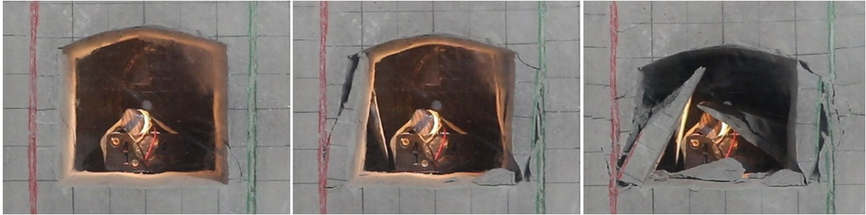
Abbildung 17 MV4 – Versagensentwicklung, Harnischfläche (rot), Trennfläche ohne Kunststoffeinlage (grün)
