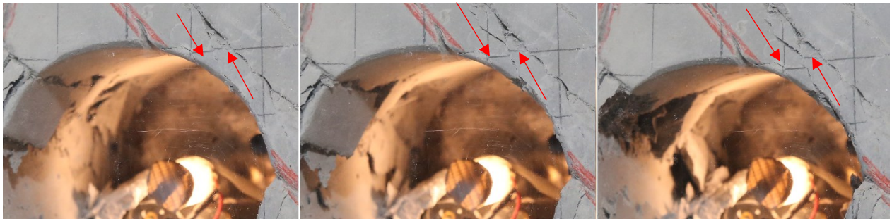
Abbildung 34 MV11 - Scherbruchentwicklung im rechten Kämpfer (rote Pfeile)
