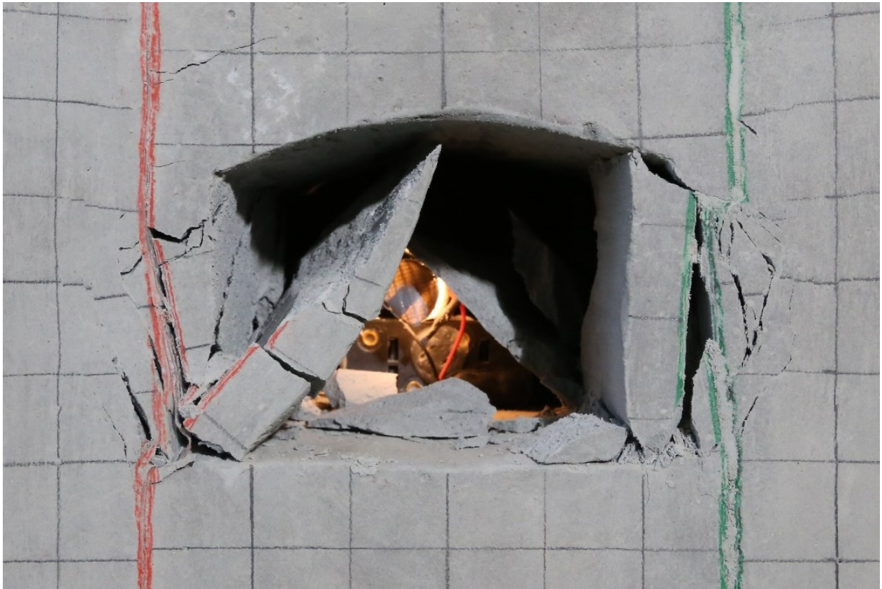
Abbildung 16 MV4 – Endzustand, Harnischfläche (rot), Trennfläche ohne Kunststoffeinlage (grün)
