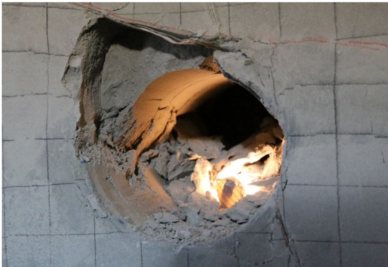
Abbildung 25 MV8 – Herabfallen des ausgeformten Blockes (nach Versuchsende, ohne Plexiglas)
