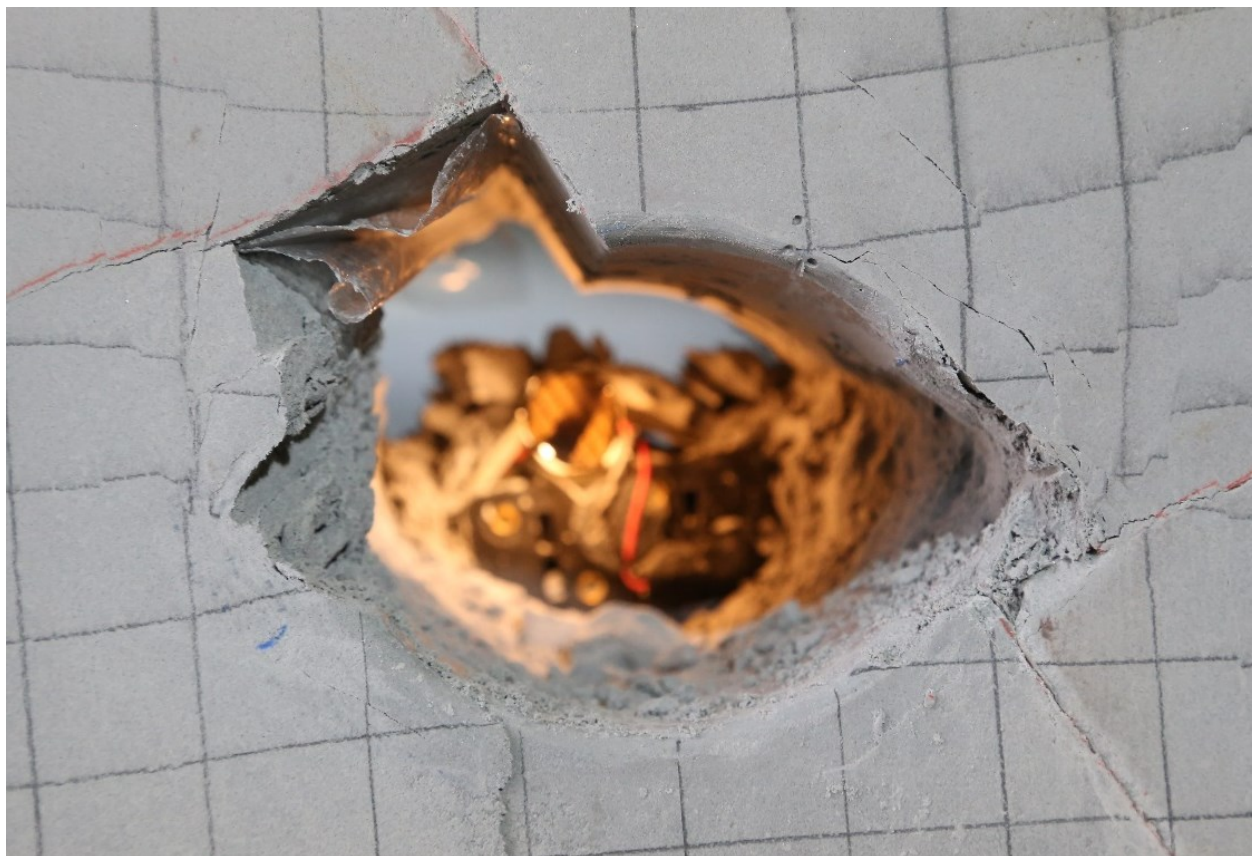
Abbildung 27 MV9 - Herabfallen des ausgeformten Blockes (nach Versuchsende, ohne Plexiglas)
