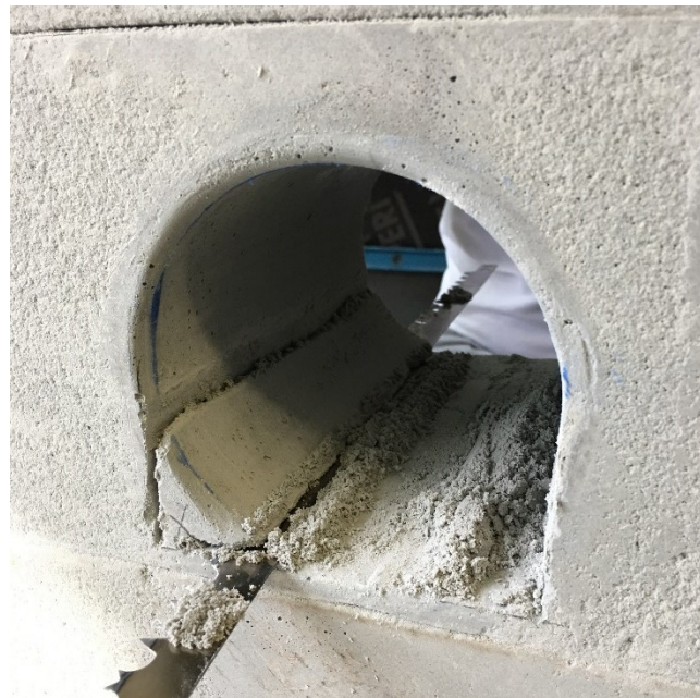
Abbildung 7 Herstellung der Kavernengeometrie (MV6)
