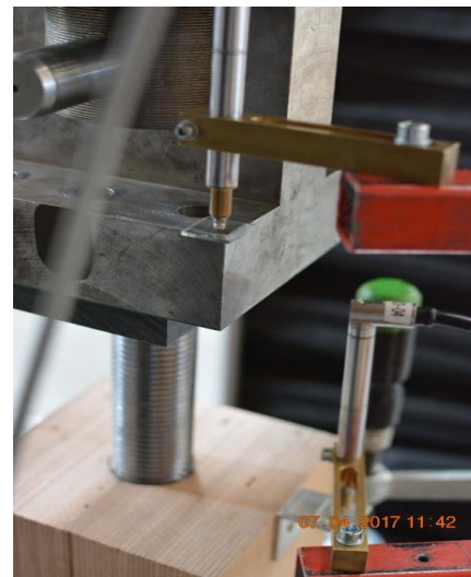
Abbildung 4-27: Prüfaufbau der Versuchsreihe 2, Druckversuch zur Bestimmung der Ausziehkenngrößen
