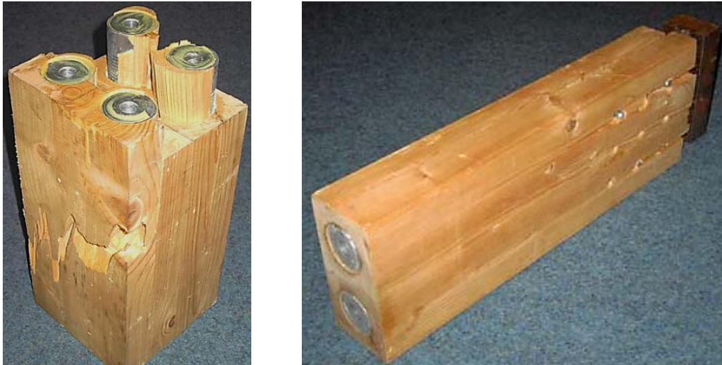
Abbildung 3-3: (a) Blockscheren einer Verbindungsmittelgruppe bei einer Last von 450 kN, (b) Prüfkörper (Schwaner et al. 2009)
