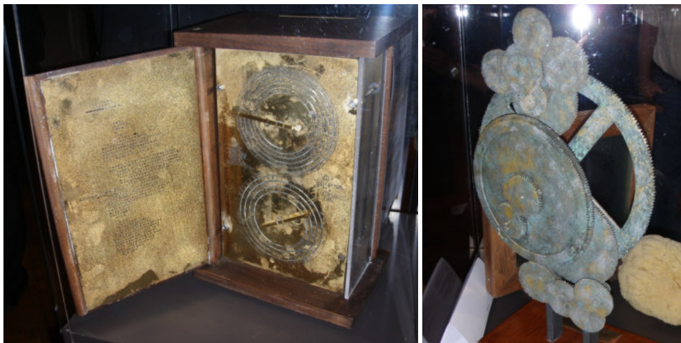
Abbildung A.2: Der Antikythera Mechanismus ist ein mechanischer Analogrechner (links – Nachbau, rechts – mechanischer Aufbau: Räderwerk, Achsen) aus den 2 Jhd. v. Chr., gefertigt aus Bronze und mit umfangreichen Aufschriften versehen. Er berechnet mit seinem Zahnradwerk Sonnen- und Mondfinsternisse, die Mondbewegung und bestimmte soziokulturelle Ereignisse (Datum der antiken Olympischen Spiele). Relevant sind der Saros Zyklus (223 Monate, Wiederholung der Sonnen- und Mondfinsternisse, 223 ist Primzahl), der Metonische Zyklus (235 Mondmonate gleich 19 Jahre), der Kallippische Zyklus (76 Jahre) und Exeligmos Zyklus (3-facher Saros Zyklus). Ausstellung "Der Mechanismus von Antikythera, ein astronomischer und kalendarischer Computer", Okt./Nov. 2011, Schloss Pöllau, Steiermark.
