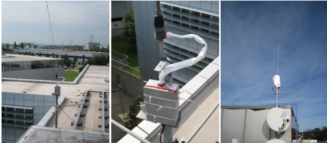
Abbildung 4.6: VLF Antennensystem zur Bestimmung der Ausbreitungseigenschaften von elektromagnetischen Wellen im Bereich von \sim 15 - 48 kHz zwischen weltweit verteilten Sendestationen und dem Empfänger am Dach des IWF's in Graz, siehe Tab. 4.2. Die linke Abbildung zeigt den VLF Antennenaufbau (fotografiert neben der GPS Antenne), in der Mitte ist der Vorverstärker zu erkennen und im rechten Bild die Schutz-Ummantelung mittels Oloid-Tasche.
