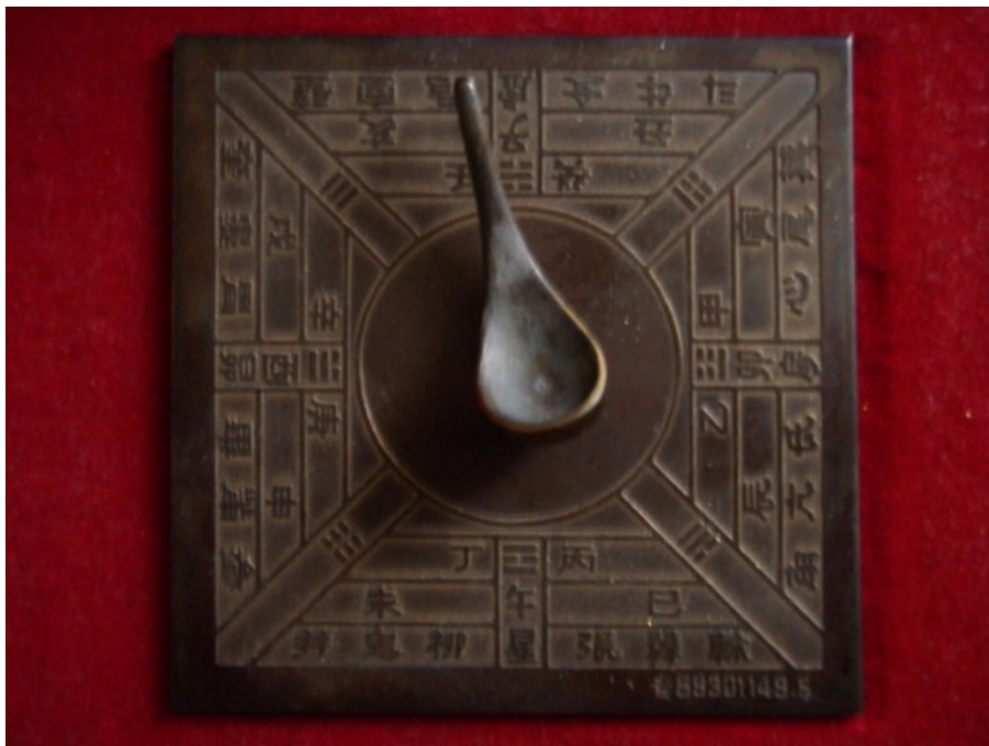
Abbildung A.8: Modell eines chinesischen Si Nan (:= der Süd-Ausrichter) Kompasses, aus heutiger Sicht weltweit der Erste seiner Art, in diesem Fall aus der Han Dynastie, 2. Jhd. v. Chr. Der Si Nan in der Form des magnetischen Löffels auf einer bronzenen Platte war zur Navigation nicht geeignet. Die Erdplatte ist modelliert nach einem Fund in Lo-Lang, Korea. Sie besitzt 24 Bereiche mit 48 Unterteilungen.
