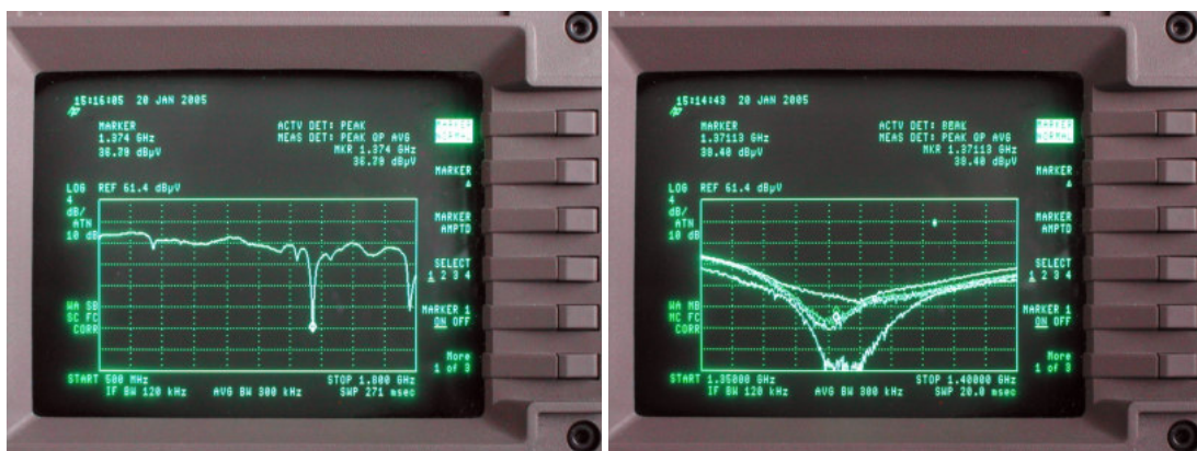
Abbildung 4.15: Schumann Frequenzen und Variation der Eigenfrequenz bei 1.37 GHz, hervorgerufen durch geringfügige mechanische Verformung an den Sieben, der leitfähigen äußeren Berandung – d. h. durch Veränderung der "Ionosphäre" des Modells.
