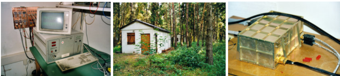
Abbildung C.4: Komponenten der Meßanlage in Magnetsrode während der Bodenkalibration für die Magnetometer der Cluster Mission. Im Spulenhause (Bildmitte) befindet sich das Instrument (rechtes Bild) und der Spacecraft Interface Simulator (linkes Bild), die Steuerung erfolgt aus dem Nebengebäude.
