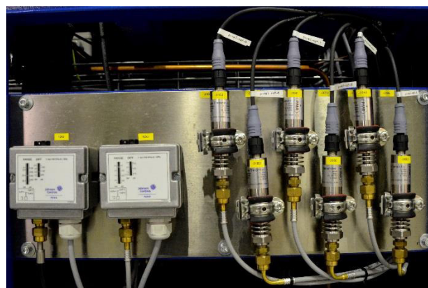
Abbildung 3-17: Montage der Druckaufnehmer
