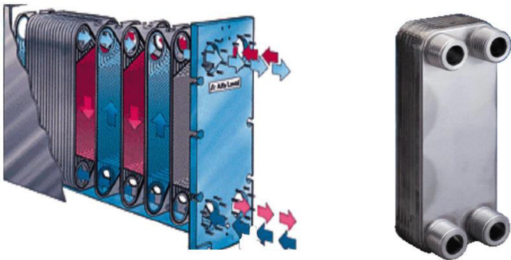
Abbildung 2-13: Schematischer Aufbau eines Plattenwärmetauschers (Rieberer, 2015b)
