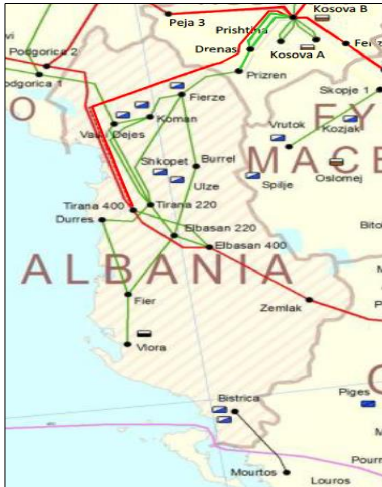
Abbildung 29: Das 400 kV- und 220 kV- Netz in Albanien 80
