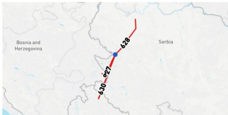
Abbildung 50: Projekt 227 mit der 400 kV Leitung (Nr. 630) zwischen Montenegro und Serbien (ENTSOE, 2016)
