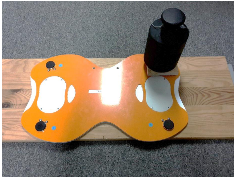
Abbildung 20: Justierung des Kraftsensors mit 10kg Prüfgewicht
