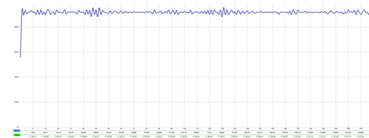
Abbildung 52: Messung der Bluetooth Übertragungsrates des Redesign aus 6m Entfernung
