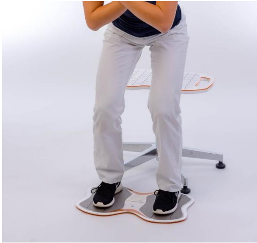
Abbildung 2: Messung des Schwerpunktes durch Kraftmessung [6]
