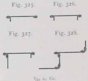
Zwei auf einander folgende Stufen bleiben häufig ohne wechselseitige Ver- bindung; will man indess eine recht solide Construction erzielen, so ordne man an der Stelle, wo Hinterkante der Trittstufe und Unterkante der Setzstufe zusamen- treffen, ein weiteres L-Eisen an, welches mit diesen beiden Constructionstheilen ver- nietet wird (Fig. 328).
