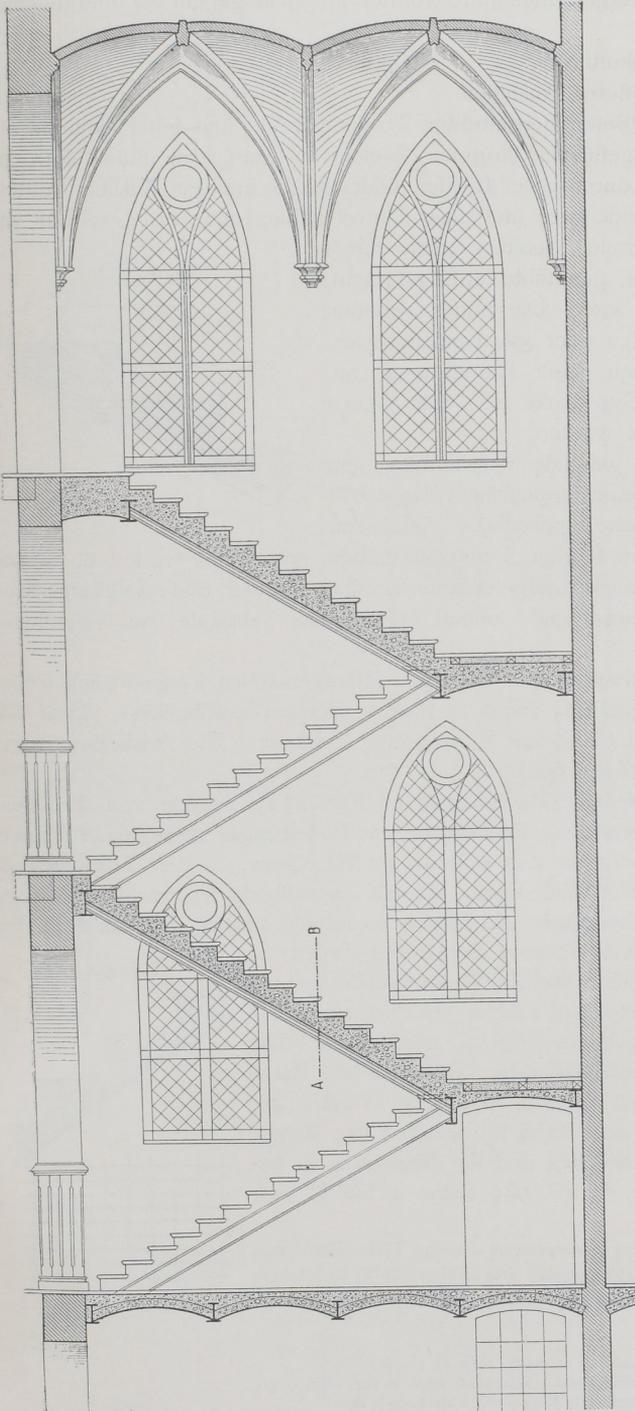
Zur Befestigung des Holzbelages sind für jede Stufe 3 schwalbenschwanzförmige eichene Dübel eingebracht. Die Einrüstung wurde nach 10 bis 12 Tagen fortgenommen. Alle Unebenheiten und Mängel wurden durch Cementputz oder Abstemmen hervortretender Theilchen beseitigt.
