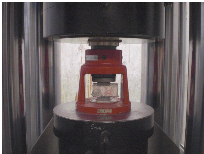
Abb. 4.6: Aufbau Druckfestigkeitsprüfung, Prismen
