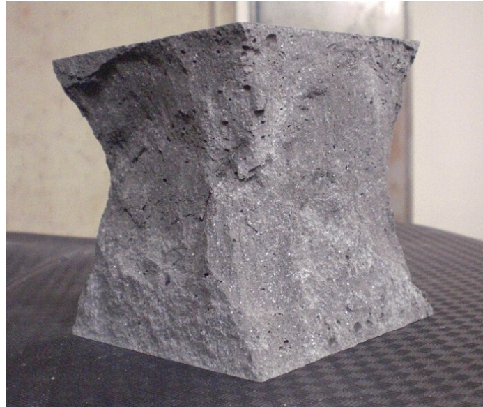
Abb. 5.7: Bruchform der Mischung M1 nach der Druckfestigkeitsprüfung
