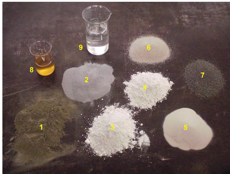
Abb. 3.1: Übersicht Ausgangsstoffe: Zement (1), Mikrosilika (2), Quarzmehle (3,4), Quarzsande (5,6), Basaltsplitt (7), Fließmittel (8), Wasser (9)
