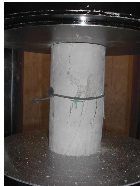
a) Bruchbild der Mischung M1 nach der Spaltzugprüfung b) Bruchbild der Mischung M2 nach der Druckfestigkeitsprüfung
