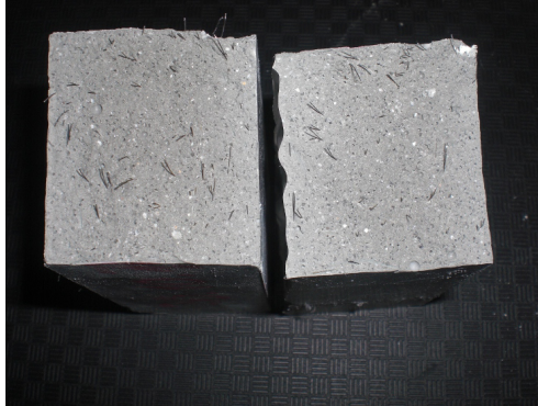
Abb. 5.4: Bruchfläche der Mischung M2 nach der Biegezugfestigkeitsprüfung
