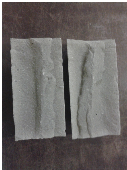
a) Bruchbild der Mischung M1 nach der Spaltzugprüfung b) Bruchbild der Mischung M2 nach der Druckfestigkeitsprüfung
