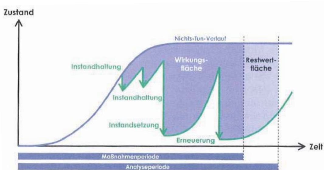
Abbildung 4: „Fläche unter der Kurve“-Prinzip (Weninger-Vycudil, 2009)
