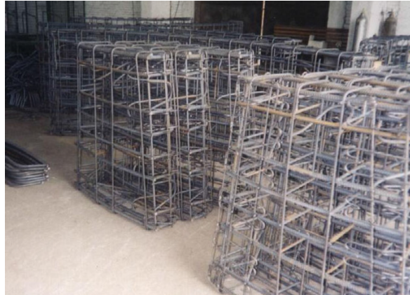
Abbildung 2.9: Bewehrung der Tübbinge (Xie et al., 2007).
