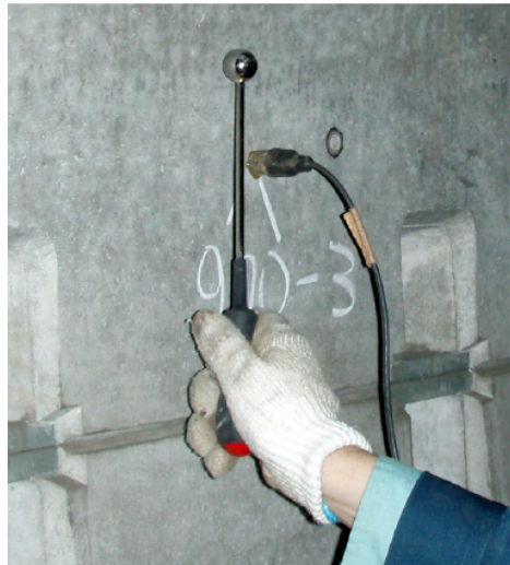
Abbildung 2.11: Messanordnung bei Impact-Echo-Verfahren (Aggelis et al., 2008)
