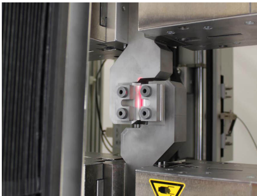
Abbildung 61 Durchführung der Scherzugprüfung
