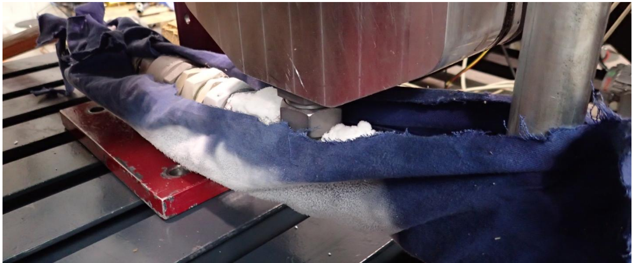
Abbildung 44: Trockeneis an der Ablassverrohrung
