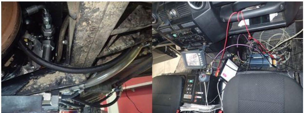
Abbildung 63: Füllstandsmessung, Leitungsführung und Verkabelung der Messtechnik
