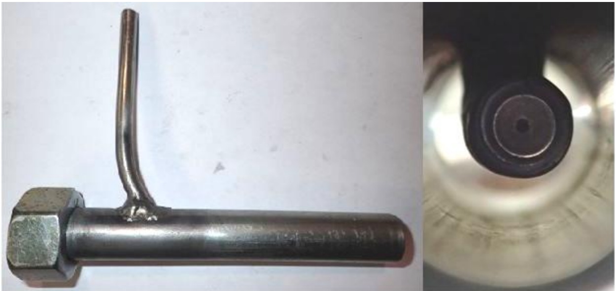
Abbildung 60: Strahlpumpe 2.0 mit \varnothing 1 mm Düse
