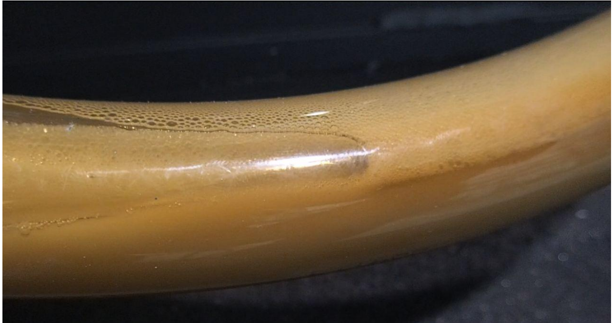
Abbildung 39: Luftausgasung im Verbindungsschlauch
