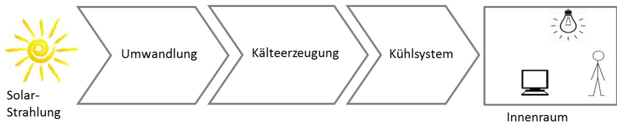
Abbildung 2-1: Grundkonfiguration des Systemaufbaus (IWT, 2014)
