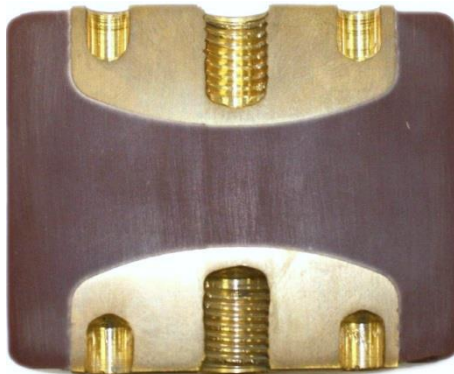
Bild 4-8: Querschnitt durch den Giesharzisolator
