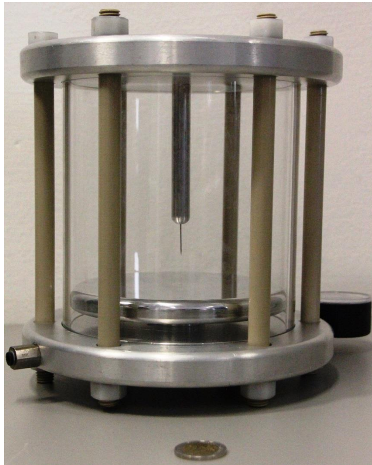
Bild 4-4: Große Testzelle mit einer Spitze auf Hochspannung
