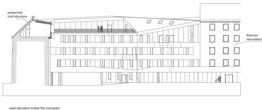
**Abbildung 39: Schnitt durch den kurzen Teil des Hauses „Paulustorgasse 4“ mit dem Dachgeschoßausbau (links) und Ansicht des neuen Verbindungsbaukörpers<sup>474</sup>**
