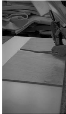
Es wird ein Fließ zum Schutz des Stoffes ausgeschnitten und mit Spezialkleber auf den Schaumstoff geklebt. Nach dem Vernähen der Ecken wird der Stoff über die Polsterplatte gezogen.
