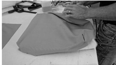
An der Unterseite wird der Stoff straff gezogen und mit Klammern am Holz befestigt. Für das Optische wird noch ein Fließ zur Abdeckung der Klammer angebracht.
