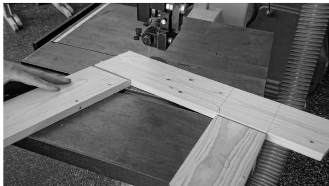
Mit Hilfe der Bandsäge wird die entgültige Form so genau als nur möglich ausgeschnitten. Kleinere Probleme gab es am Anfang durch den zu geringen Radius der Bandsäge.
