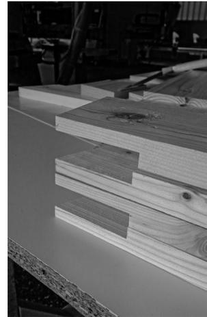
Vor dem Leimen werden noch die optischen Schrägen mit der Schleifmaschine im 45° Winkel abgeschragt. Dabei wird eine Restbestand von ca. 2 mm übrig gelassen, um ein besseres Zusammenbauen zu gewährleisten.
