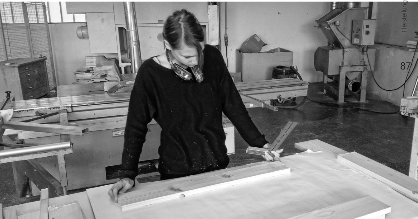
Die Bretter werden durch Abmessen des Planes mit einer Überlänge von ca 3 cm pro Seite zugeschnitten. Diese 3 cm sind für ein optimales Schneiden wichtig, da man beim Abschrägen zuerst kontrollieren muss, ob die Winkel auch exakt passen. Da mit der Tischkreissäge geschnitten wird, ist das eben nicht immer der Fall.
