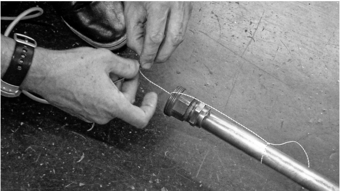
Da das Hauptgerüst der Lampe bereits im Vorgebrauch zusammengeschweißt war, müssen wir mit Hilfsmitteln versuchen, die Kabel durch die vielen Winkel einzuziehen. Dies gelingt dann mit Hilfe einer kleinen Metallkugel und einem Kompressor.
