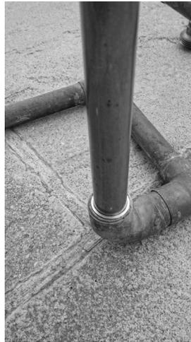
Zur besseren Stabilität wird an der Unterseite noch eine zusätzliche Stütze angeschweißt.
