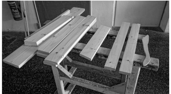
Bogenmaße und Winkel werden nach den Plänen angezeichnet, und Flächen, welche für die Überlappung ausgeschnitten werden, markiert.
